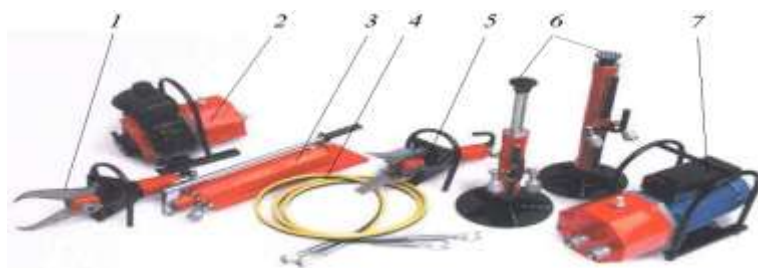
Рисунок 1.13 – Гидравлические инструменты: 1 резак комбинированный; 2 маслостанция; 3 домкрат; 4 гидравлические рукава высокого давления; 5 расширитель гидравлический; 6 цилиндр гидравлический одноштоковый; 7 маслостанция
