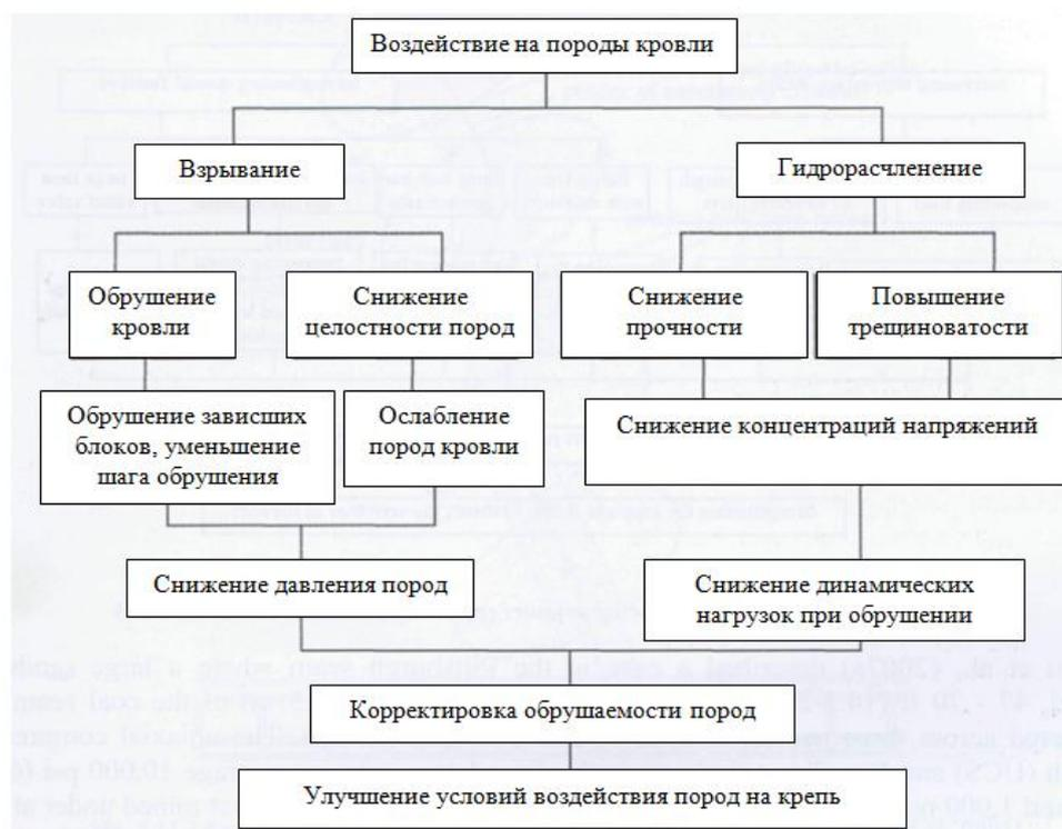
Рисунок 1.13 – Блок-схема способов воздействия на породы труднообрушаемой кровли
