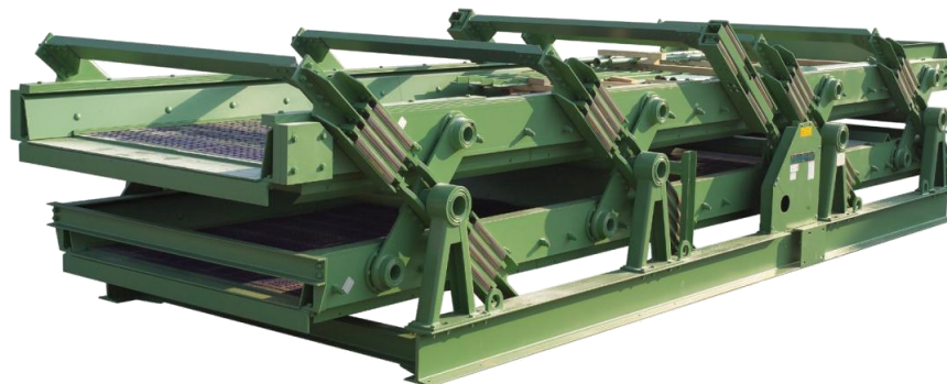
Рисунок 1.6 - Грохот резонансный производства Binder+Co AG [103]
