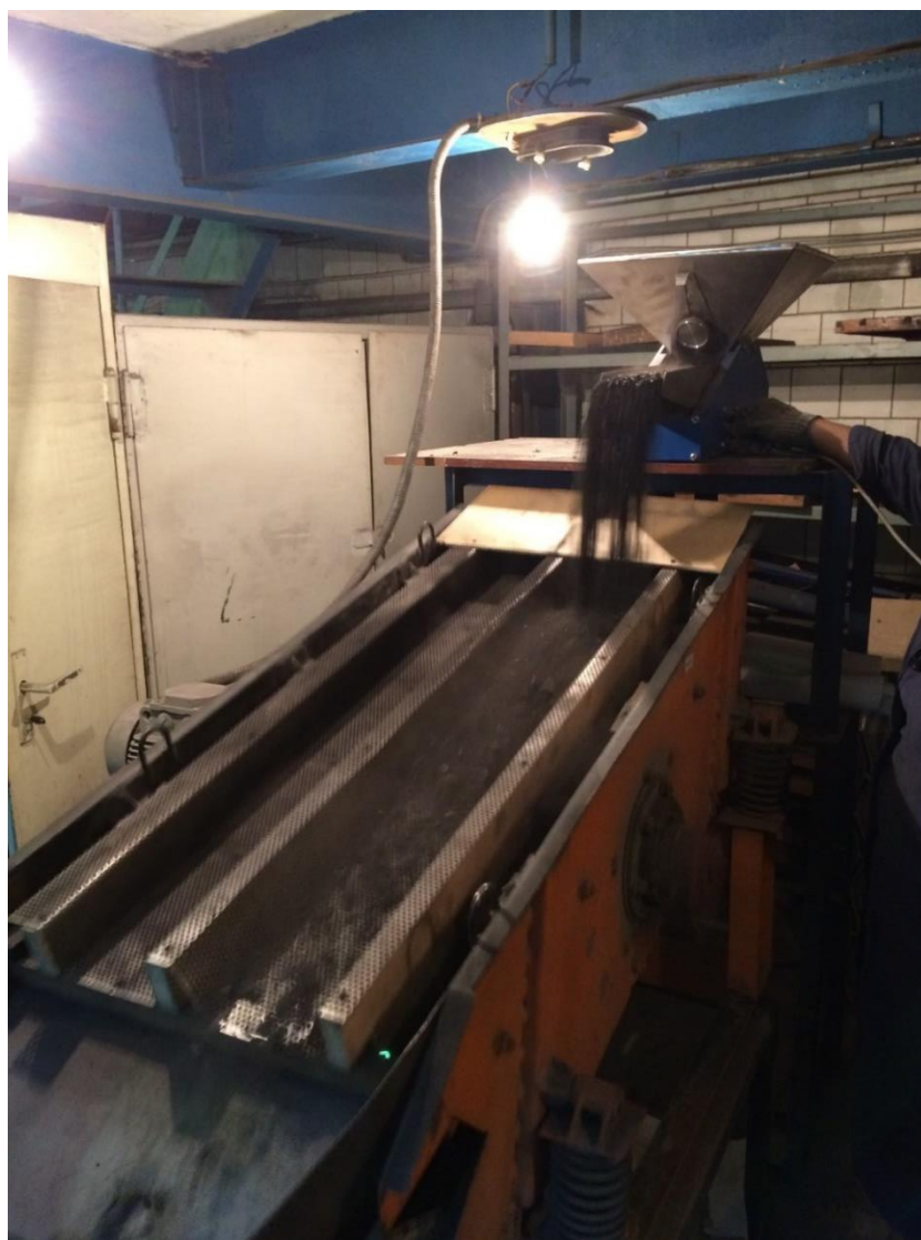
Рисунок 4.18 - Испытания процесса «градиентной» вибрационной классификации сыпучих материалов
