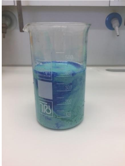
Рисунок 3.6 – Разрушение медно-аммиачного комплекса
