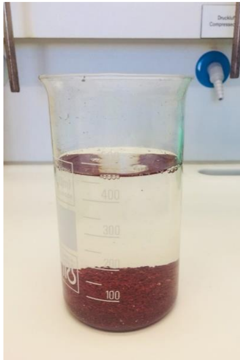
Рисунок 3.8 – Образование оксихлоридного коагулянта и медьсодержащего шлама
