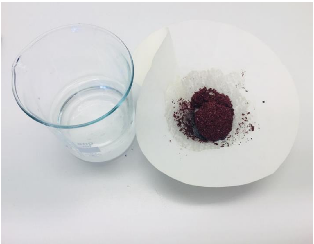
Рисунок 3.9 – Отделение раствора оксихлоридного коагулянта от медьсодержащего шлама фильтрованием
