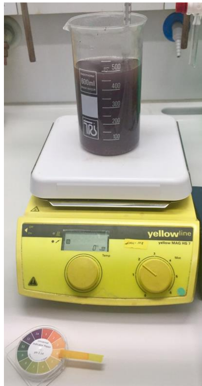
Рисунок 3.7 – Взаимодействие металлического алюминия с медно-аммиачным отходом
