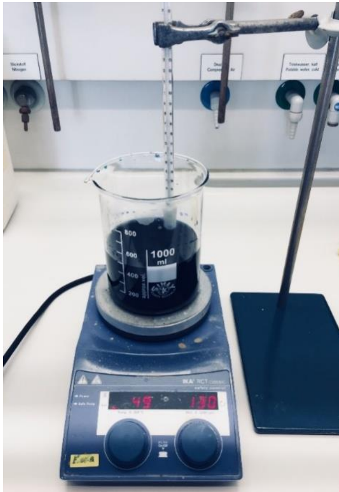
Рисунок 3.5 – Получение отработанного медно-аммиачного раствора
