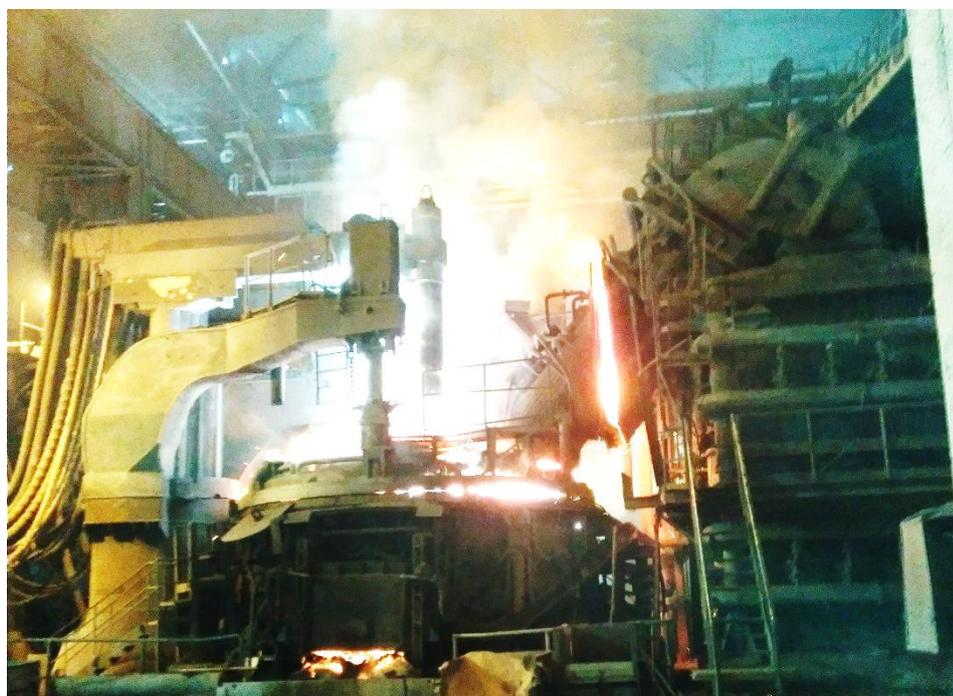
Рисунок 1.3 – Дуговая сталеплавильная печь
