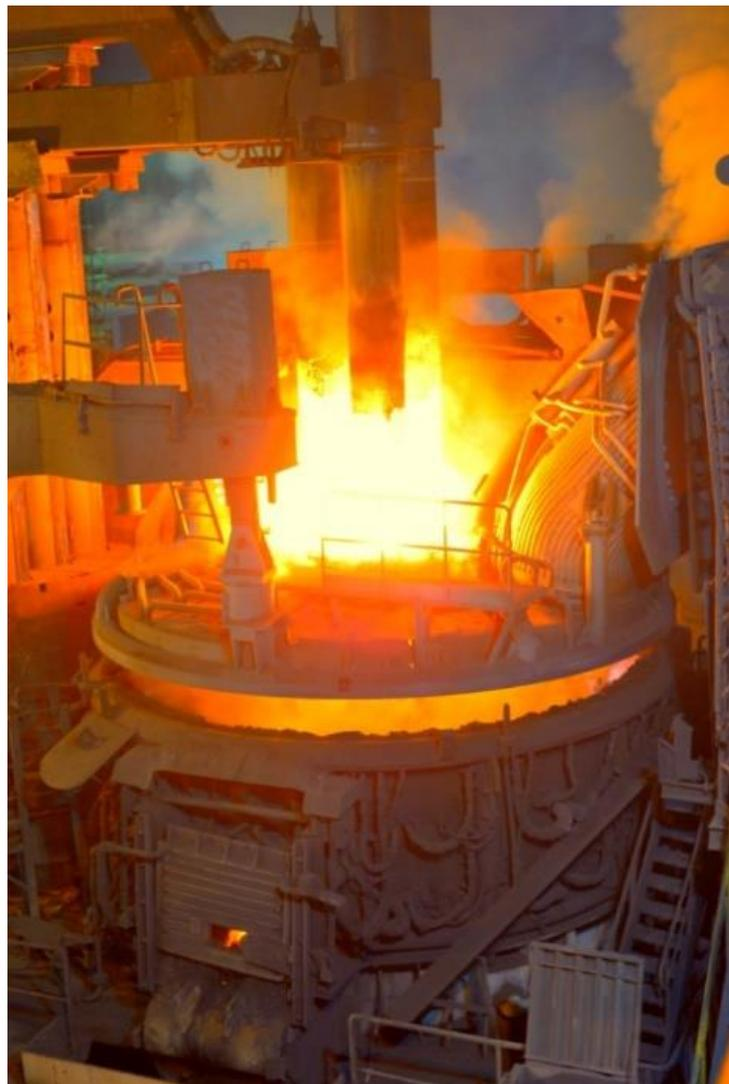
Рисунок 2.3 – Дуговая сталеплавильная печь ДСП-90
