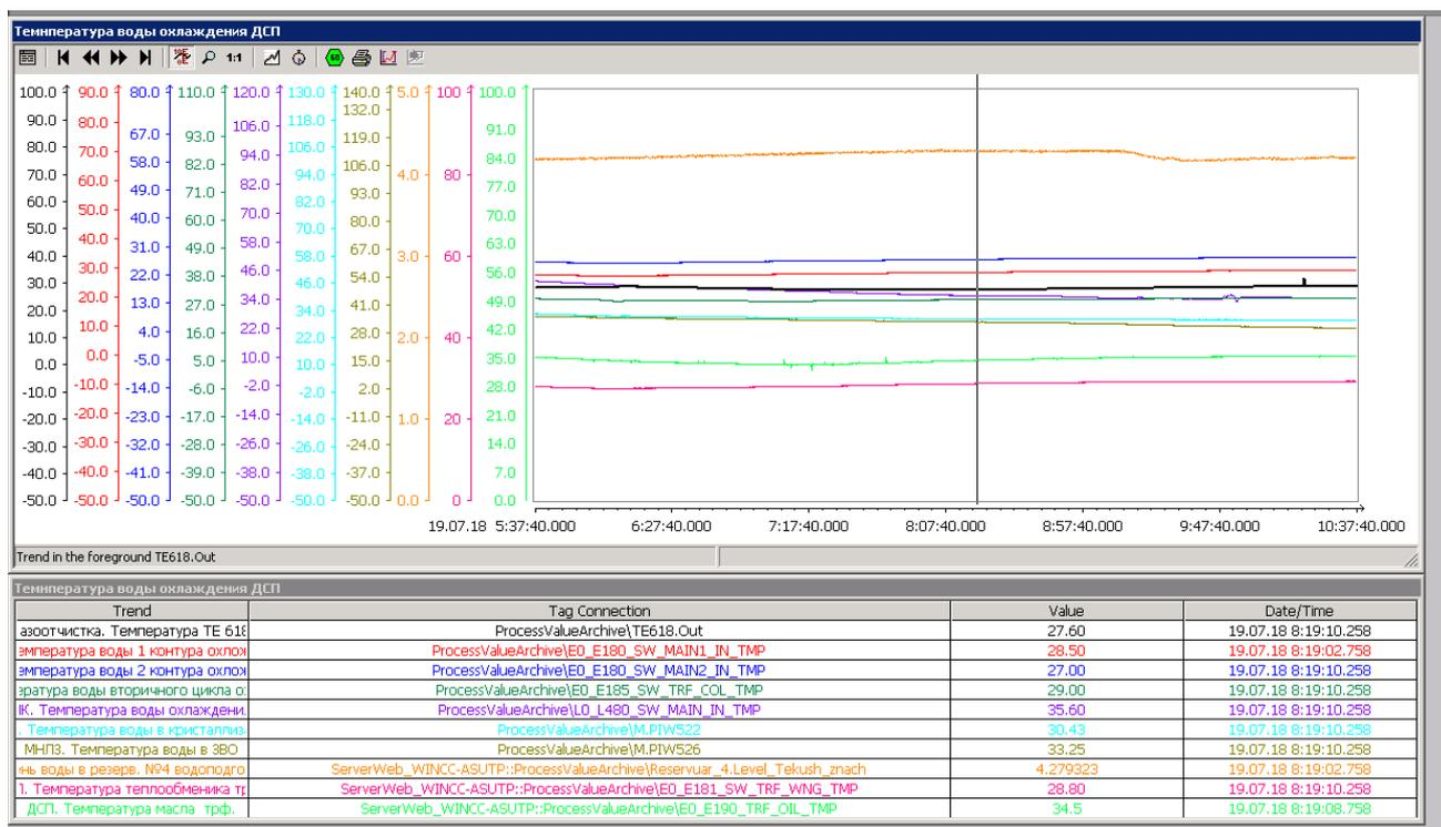
Рисунок 3.15 – Графики температуры воды охлаждения и днища ДСП, полученные из SCADA-системы
