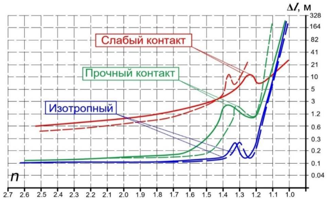
Рисунок 4.2 – Зависимость максимальных смещений ( \Delta l ) от коэффициента запаса ( n ) на каждом этапе отработки (ось Y имеет логарифмический масштаб; пунктирная линия характеризует результаты расчетов методом алгебраического сложения сил, сплошная линия – методом конечных элементов)
