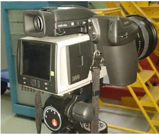
Рисунок 3.11 – Вид фоторегистратора Hasselblad H5D-200MS и видеореги­стратора NAC HX-3.
