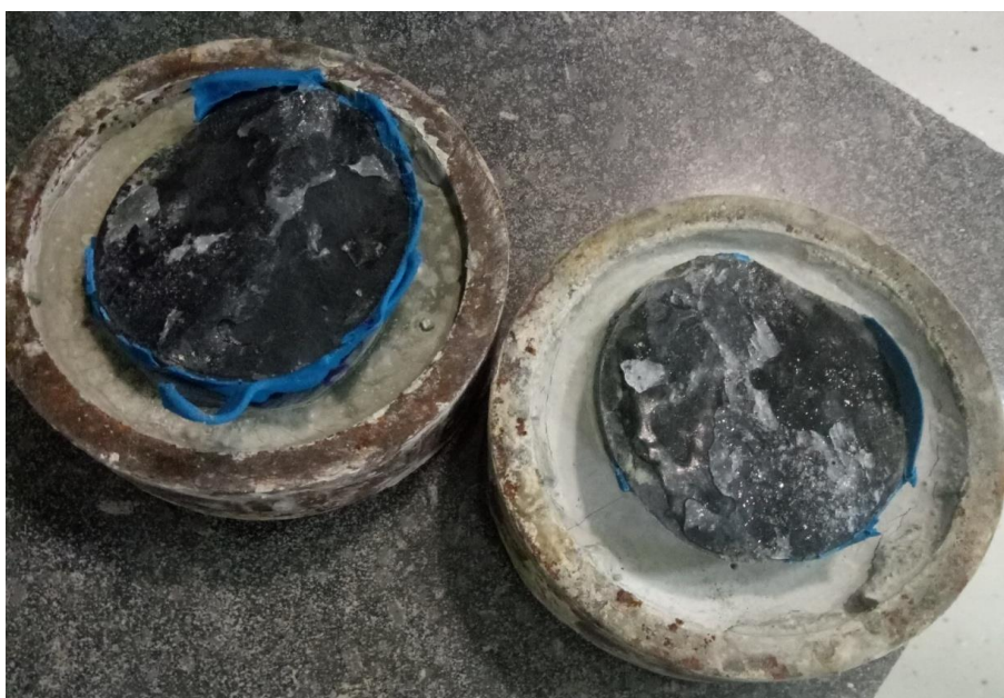
2.26 – Образец скальной породы при наличии льда на контактах
