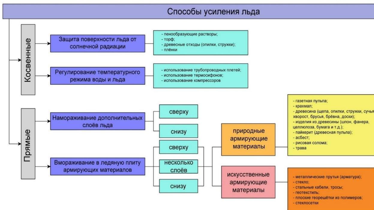
Рисунок 3.8 - Классификация способов усиления льда
