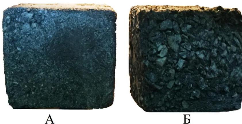
Рисунок 3.20 -Примеры образцов льдопородной закладки (10x10x10см):
