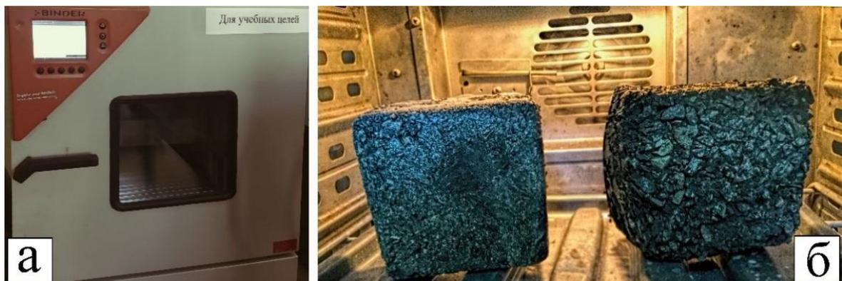
Рисунок 3.12 - Климатическая камера Binder (а) и процесс выдержки в ней образцов (б)
