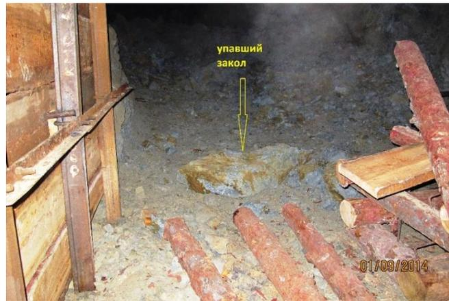
Рисунок 2.4 – Пример отслоения горной массы с кровли выработки на одном из рудных месторождений Хабаровского края
