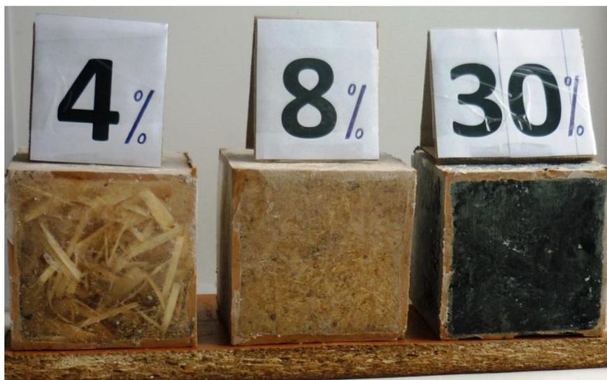
Рисунок 3.15 – Образцы кубической формы, подготовленные для испытания на сжатие (лёд с 4 % стружки, 8 % опилок, 30 % резинокордовой крошки)
