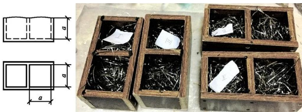
Рисунок 3.13 – Двухместная форма для изготовления образцов в виде куба
