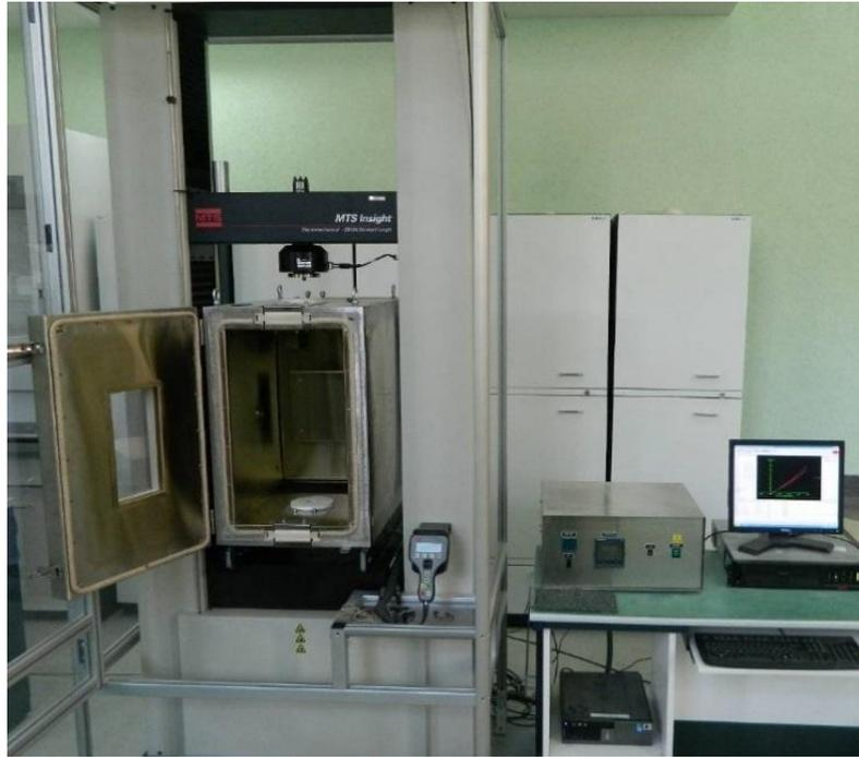
Рисунок 3.11 - Общий вид электромеханической испытательной машины Insight 200 кН с климатической камерой
