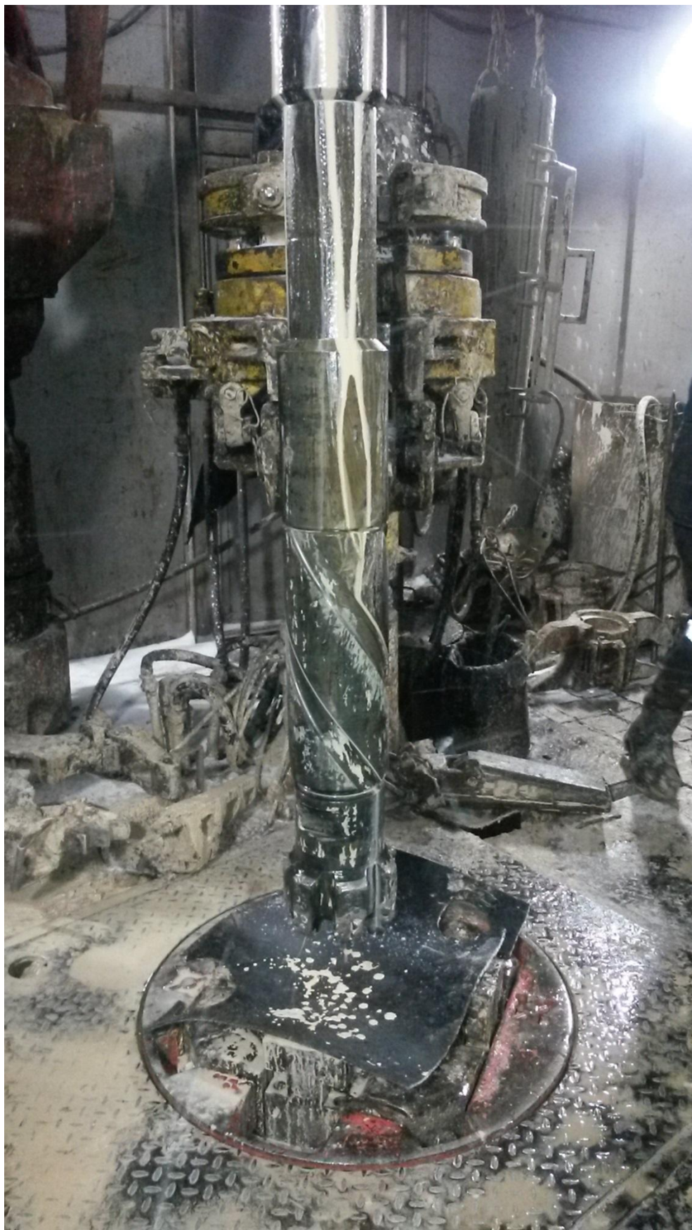
Рисунок 4.1 - Вид собранной КНБК при проведении опытно-промысловых испытаний на скважине
