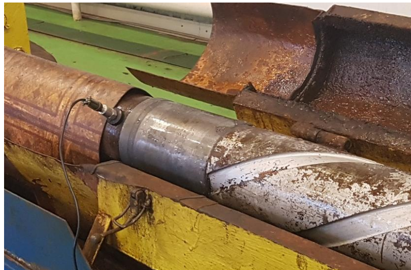
Рисунок 3.20 – Виброизмерительный прибор, установленный на теле осциллятора-турбулизатора перед началом испытаний
