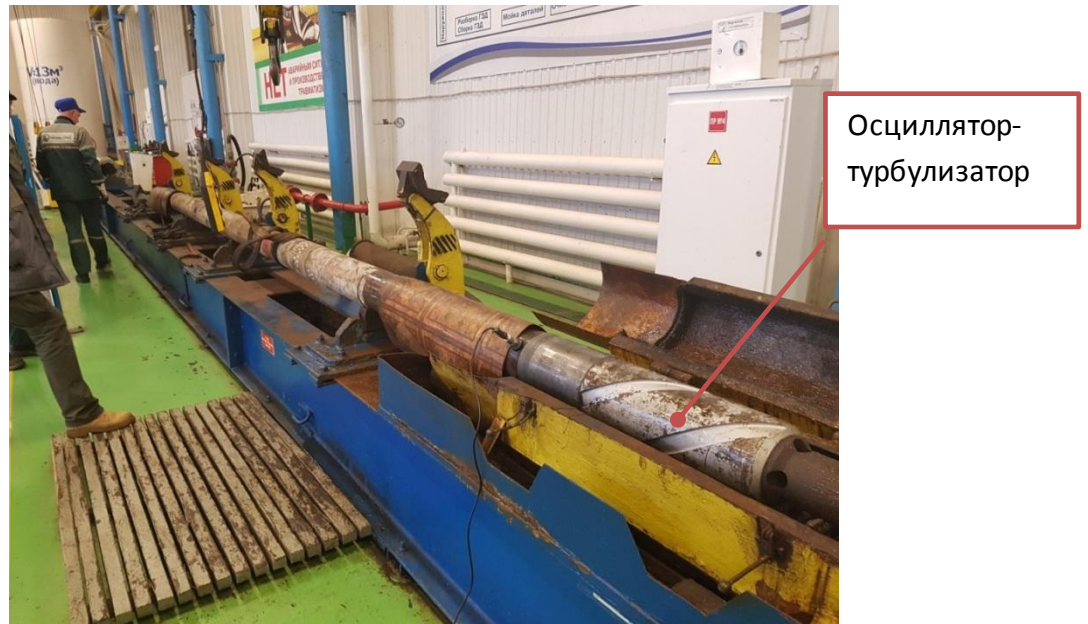
Рисунок 3.19 - Вид собранного в КНБК осциллятора перед началом испытаний
