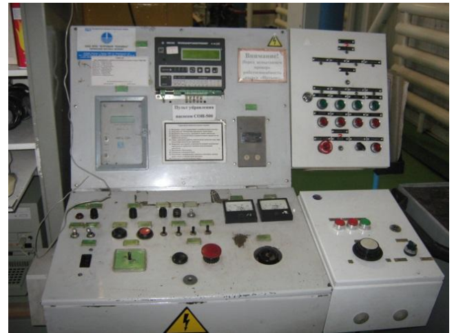
Рисунок 3.12 - Пульт управления обкаточно-испытательного стенда типа СОИ500
