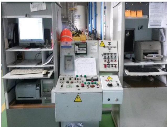
Рисунок 3.12 - Пульт управления обкаточно-испытательного стенда типа СОИ500
