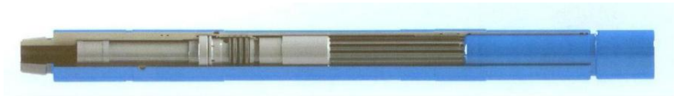
Рисунок 1.7 - Корректор подачи-демпфер типа КПД [39]
