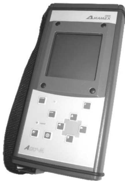
Рисунок 3.14 - Виброизмерительный прибор «АГАТ-М»
