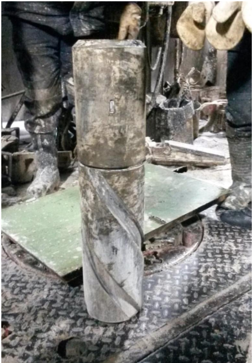
Рисунок 4.2- Внешний вид осциллятора после проведения промысловых испытаний
