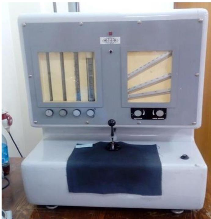
Рисунок 3.6 - Прибор FF-12 для измерения воздухопроницаемости с загрязненным образцом
