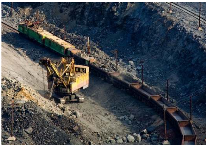
Рисунок 1.2 – Применение железнодорожного транспорта в отработке железистых кварцитов и скальной породы
