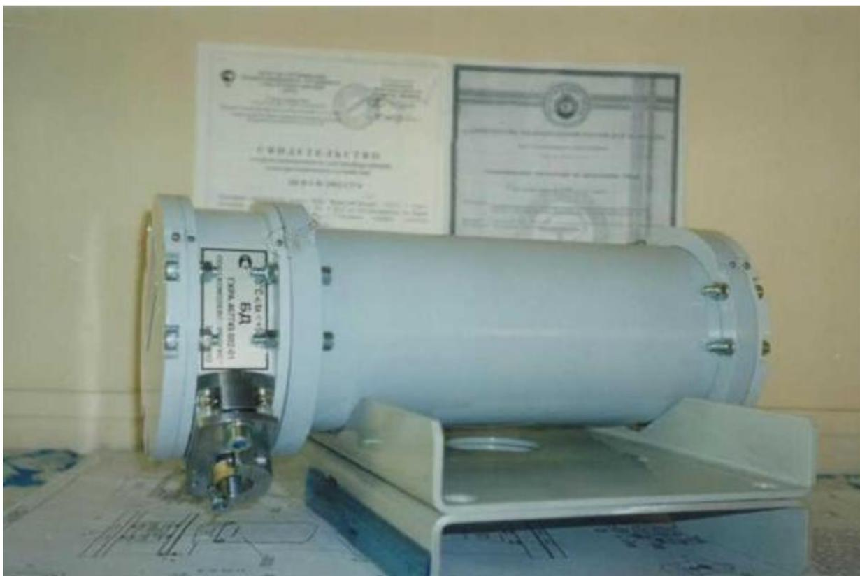
Рисунок 4.1 – Блок детектирования измерительной установки «Нефтемер МК»
