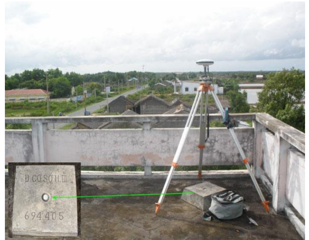
Рисунок 1.21 – Вид пункта ГГС (на крыше здания)
