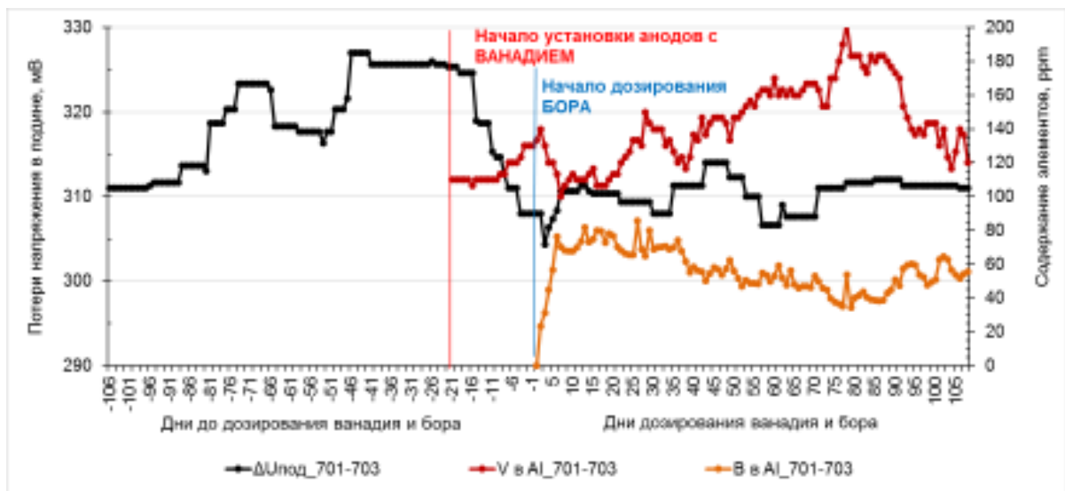
Рисунок 4.14 – Динамика потерь напряжения в катоде и содержания элементов опытных электролизеров 701, 702 и 703 (средние значения по группе)
