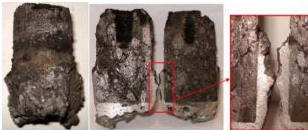
Рисунок 3.63 – Внешний вид катода УГ5 после эксперимента
