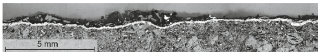
Рисунок 1.9 – Слой карбида алюминия на поверхности углеродного катода (светлый). Слой осадка (электролит, глинозем и металл) покрывает слой карбида [35]
