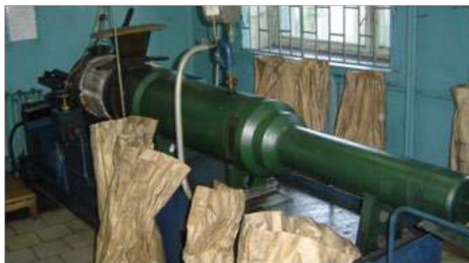
Рисунок 3.90 – Гидравлический прошивной пресс 100 тонн
