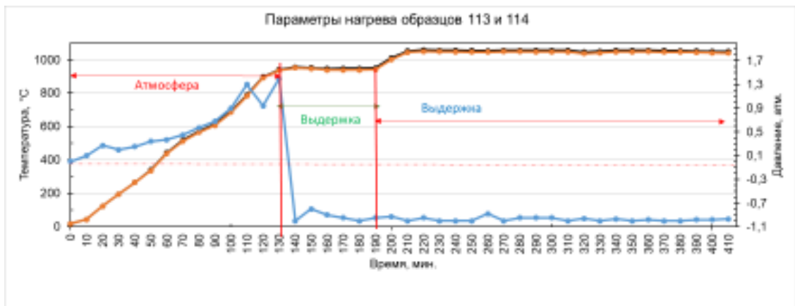
Рисунок 2.32 – Технологические условия проведения экспериментов для исходной смеси 1TiO_2-7B_2O_3-16C
