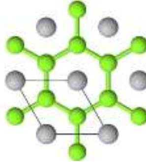
Рисунок 1.48 – Виды с боку и сверху кристаллической структуры типа AlB_2 [227]
