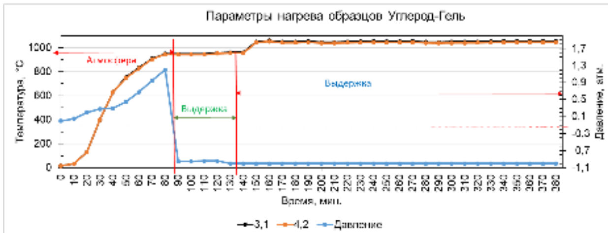
Рисунок 2.42 – Технологические условия проведения экспериментов с композициями Углерод - Гель
