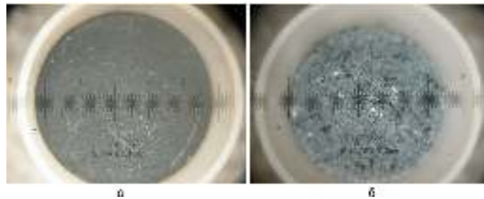
Рисунок 2.13 – Микрофотографии таблетки образца 108 до (а) и после нагревания (б) ее в интервале от 40 до 867°C со скоростью 20°C в минуту
