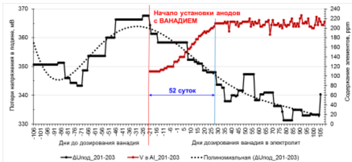
Рисунок 4.15 – Динамика потерь напряжения в катодной подине и содержания ванадия электролизеров-свидетелей 201, 202 и 203 (средние значения по группе)
