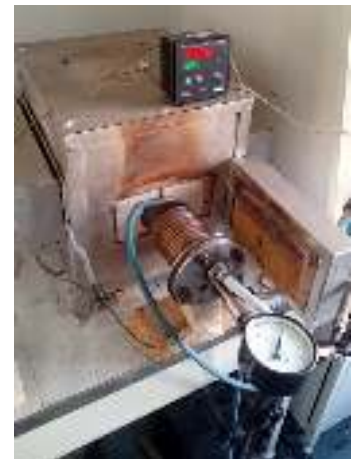
Рисунок 2.17 – Схема реакционной ячейки и установка в сборе
