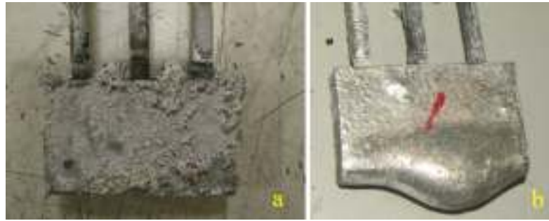
Рисунок 1.64 – Композитные катоды TiB_2-C после электролиза при 0,07 \text{ A/cm}^2 (a) и при 0,15-0,26 \text{ A/cm}^2 (b) [311]
