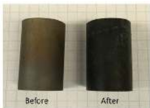
Рисунок 1.66 – Внешний вид образца TiB_2 до и после 72 часов испытаний [312]
