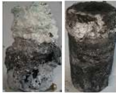
Рисунок 3.33 – Внешний вид катода УГ10 до и после очистки от электролита
