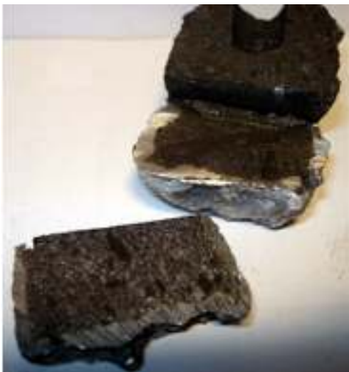
Рисунок 3.140 – Вид образца УТ7 перед отделением алюминия от углеродного катода
