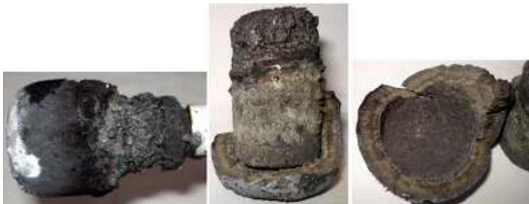
Рисунок 3.99 – Внешний вид катода УТ3 после эксперимента
