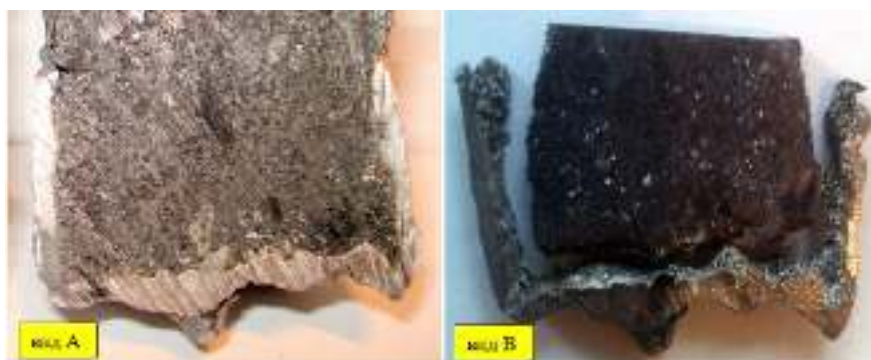
Рисунок 3.144 – Вид фрагментов образца УТ7 непосредственно после опыта (вид А) и через 14 суток (вид В) выдержки на воздухе
