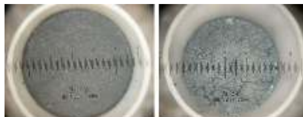
Рисунок 2.10 – Таблетки образца до (а) и после нагревания (б) до 1100^\circ\text{C} в вакууме
