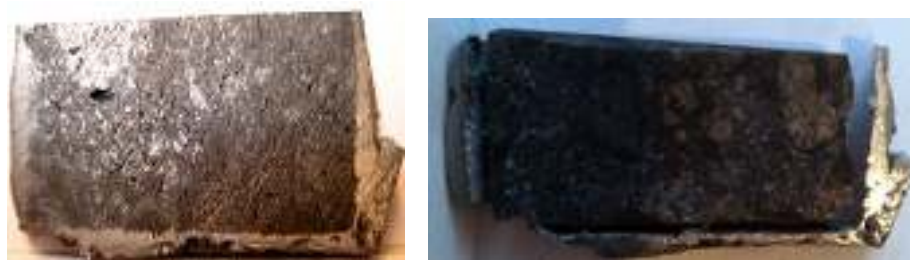
Рисунок 3.55 – Вид фрагмента образца УГ2 после опыта и через 14 суток выдержки на воздухе
