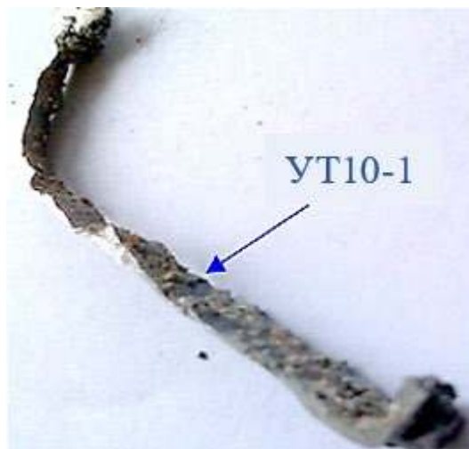
Рисунок 3.159 – Участок УТ10-1 приповерхностного слоя, примыкающие к слою алюминия со стороны поверхности катода.
