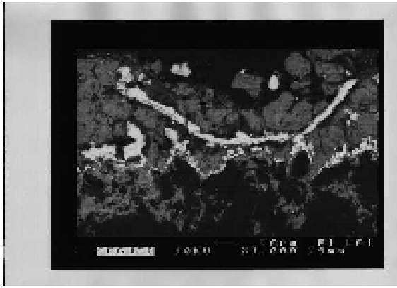
Рисунок 1.62 – Разлом покрытия TiB_2 на графите при охлаждении образца
