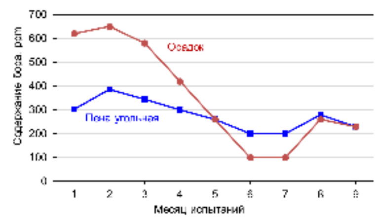
Рисунок 4.26 – Динамика содержания бора в осадке и угольной пене (электролизер №219)
