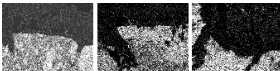
Рисунок 3.13 – EDS карты углеродной поверхности катода после электролиза ( \times 55 )
