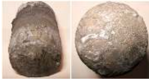
Рисунок 3.3 – Внешний вид катода УГ1 после извлечения из ячейки
