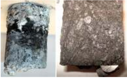
Рисунок 3.20 – Внешний вид катода УГ8 после эксперимента
