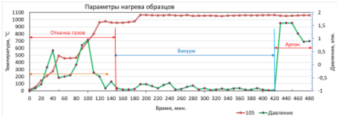
Рисунок 2.30 – Технологические условия проведения экспериментов для исходной смеси 1TiO_2-(4\div 7)B_2O_3-17C
