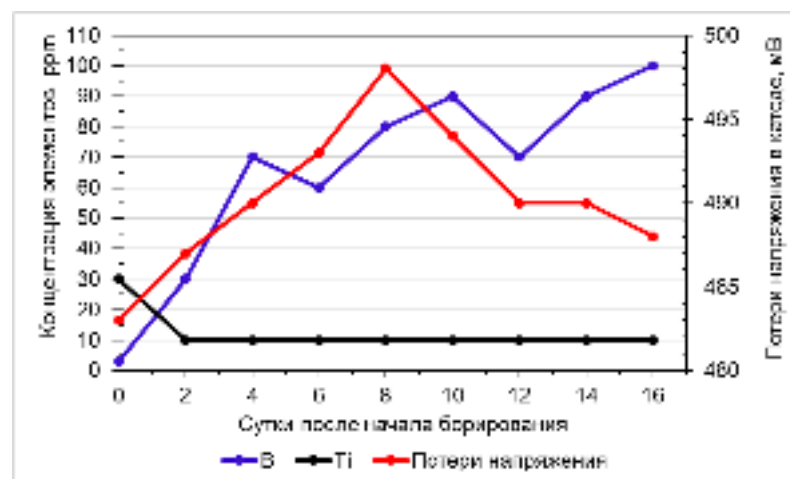
Рисунок 4.1 – Динамика борирования алюминия и потерь напряжения в катодной ванне №1
