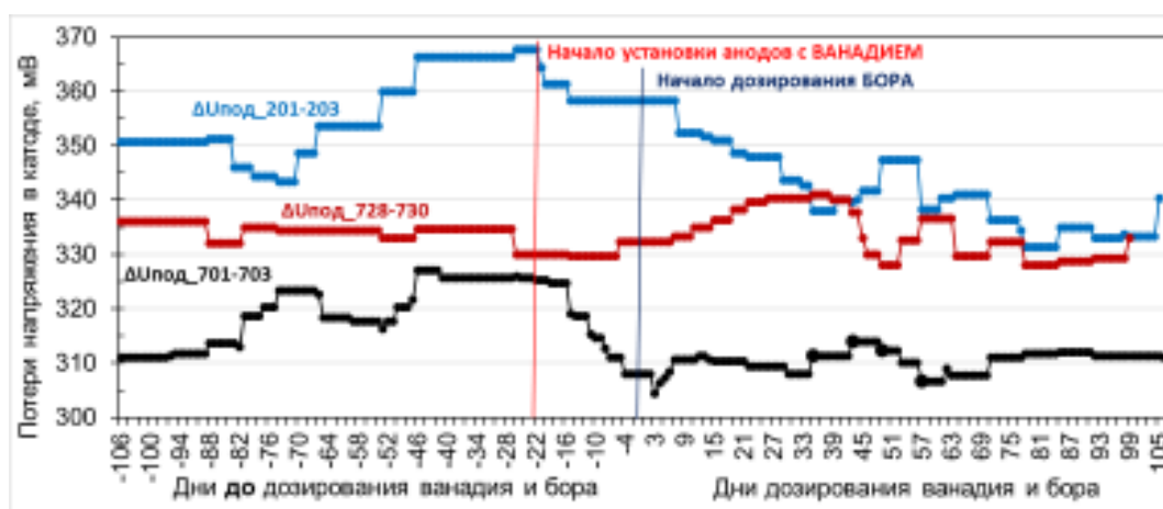
Рисунок 4.12 – Динамика потерь напряжения в катодe опытных электролизеров и ванн-свидетелей (средние по группам)
