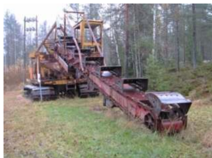
Рисунок 1.4 – Машины, применяемые при экскаваторном способе добычи кускового торфа: 1) Торфодобывающий экскаватор МТК-14, 2) стилочная машина МТК-13
