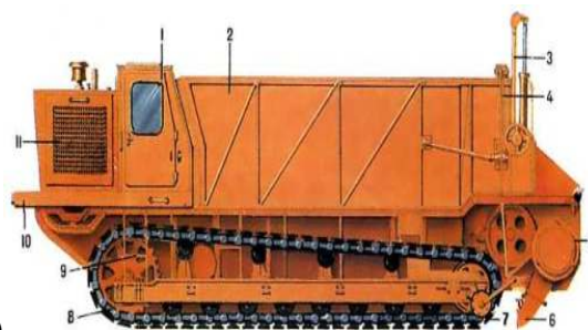
Рисунок 1.4 – Машины, применяемые при экскаваторном способе добычи кускового торфа: 1) Торфодобывающий экскаватор МТК-14, 2) стилочная машина МТК-13
