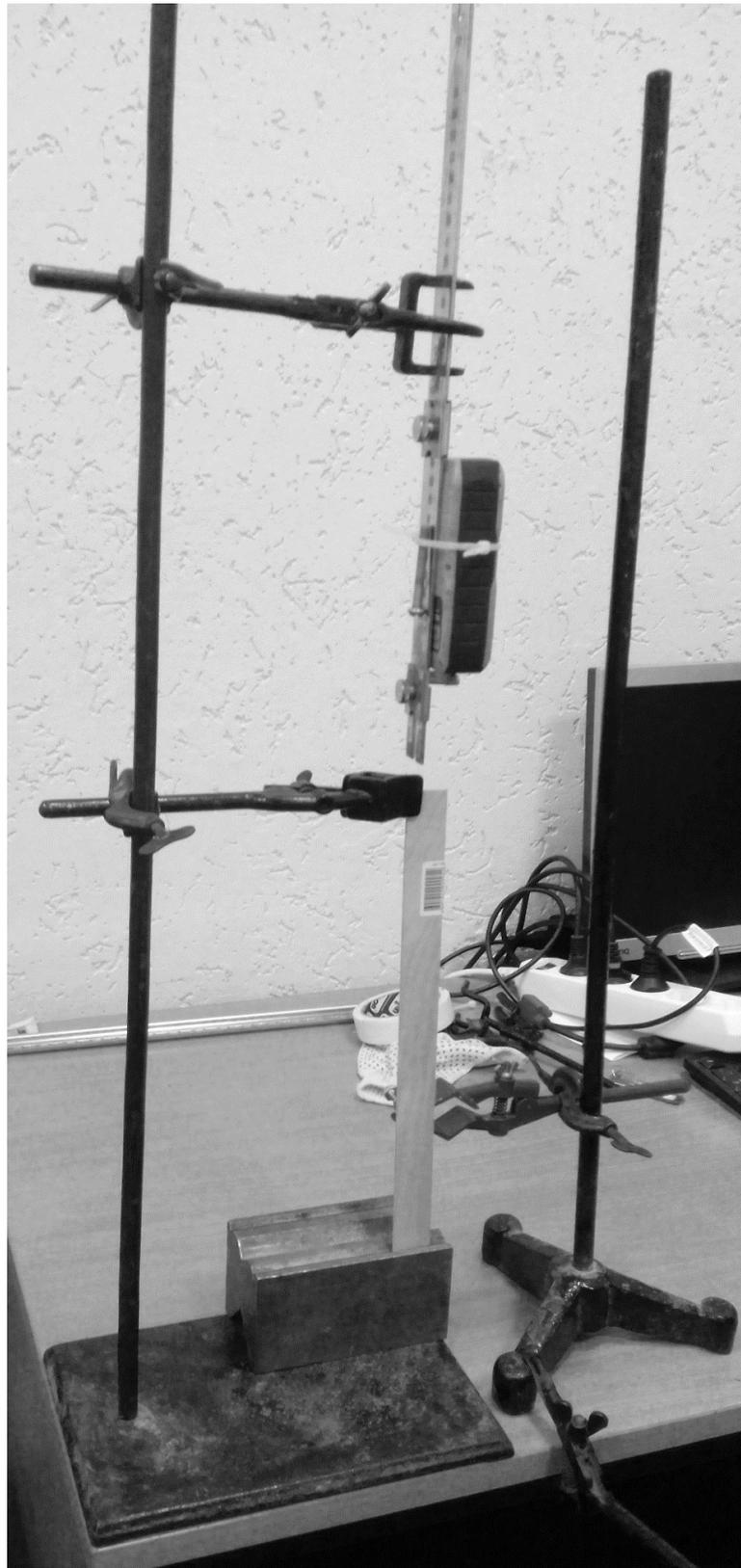
Рисунок 2.4 – Лабораторная установка для нахождения зависимости показаний лазерного измерителя от степени отклонения электрода
