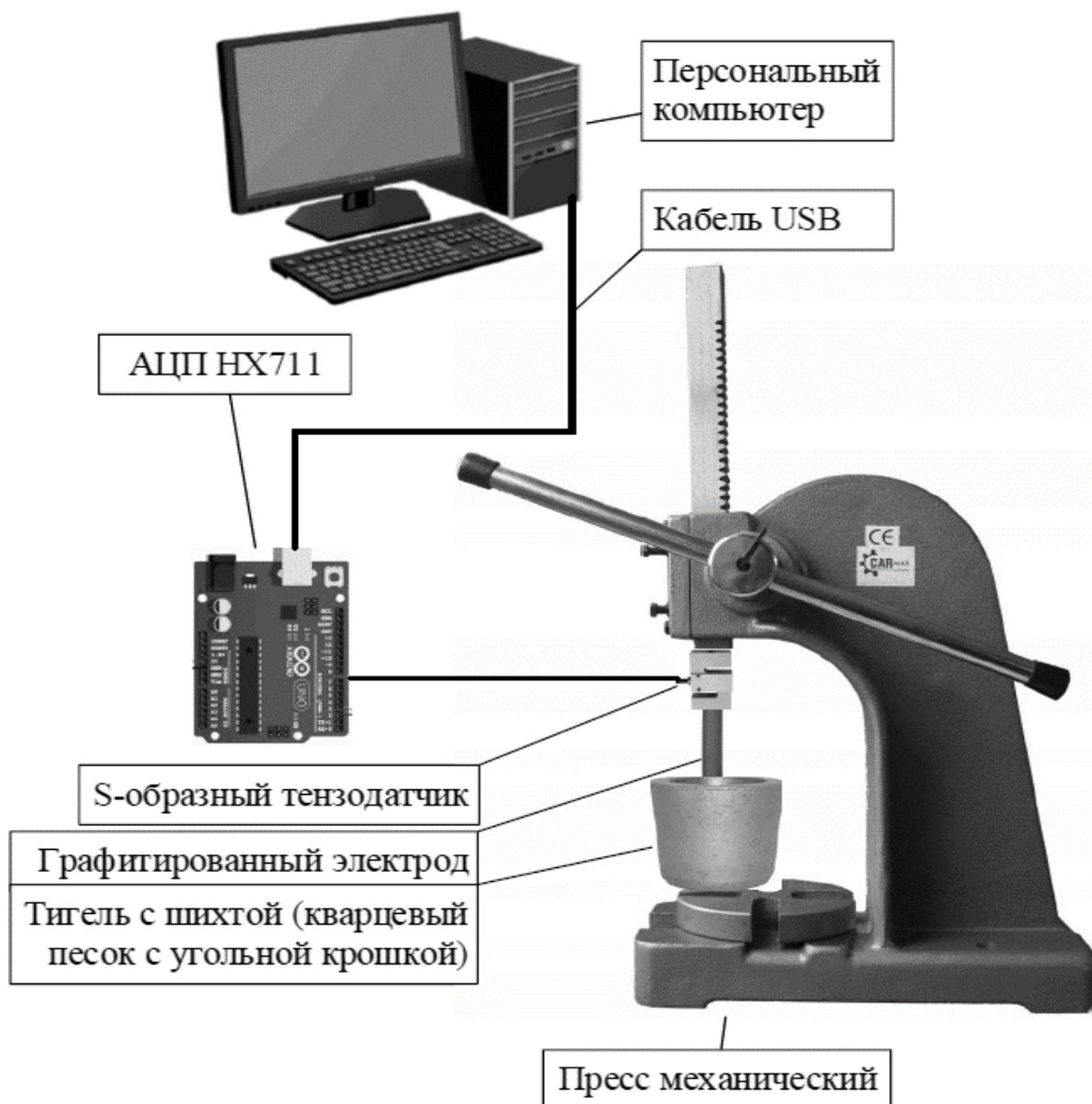
Рисунок 2.2 – Схема лабораторной установки для изучения влияние степени отклонения электрода
