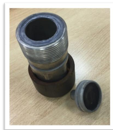
Рисунок 3.1 – Установка и автоклав для определения равновесного состава щелочных силикатных растворов, содержащих алюминат натрия
