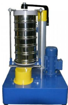
Рисунок 4.1 –Анализатор ситовой ударный АС-200У (РОТАП)
