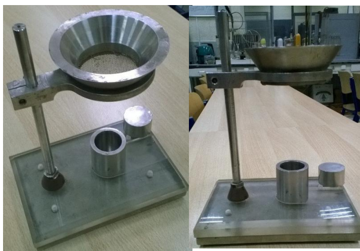
Рисунок 4.4 – Измерение насыпной плотности обожженного боксита на волюмометре
