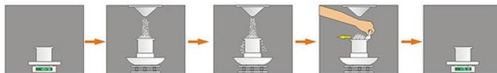
Рисунок 4.5 –Порядок определения насыпной плотности материала
