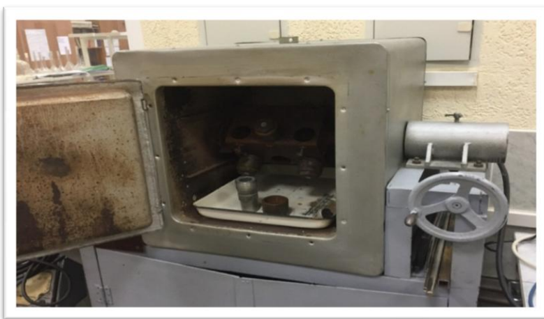
Рисунок 3.1 – Установка и автоклав для определения равновесного состава щелочных силикатных растворов, содержащих алюминат натрия
