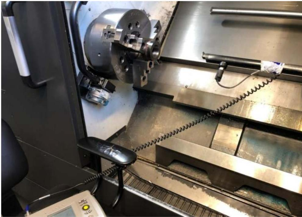
Рисунок 2.15 – Определение свойств демпфирования стандартной и антивибрационной расточной оправки
