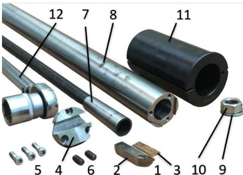
Рисунок 2.12 – Напряжённно-деформированная расточная оправка в разобранном виде
