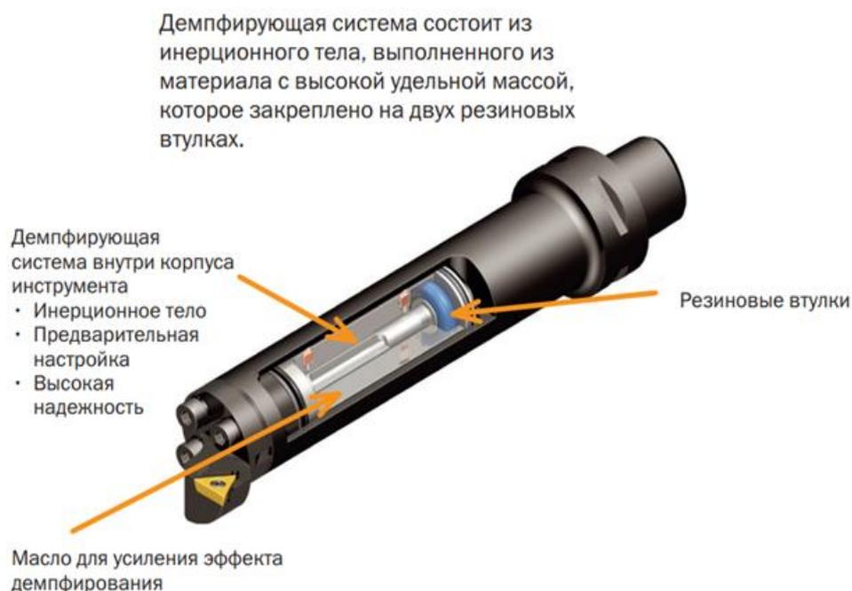
Рисунок 1.15 – Расточная оправка Silent Tools компании Sandvik Coromant
