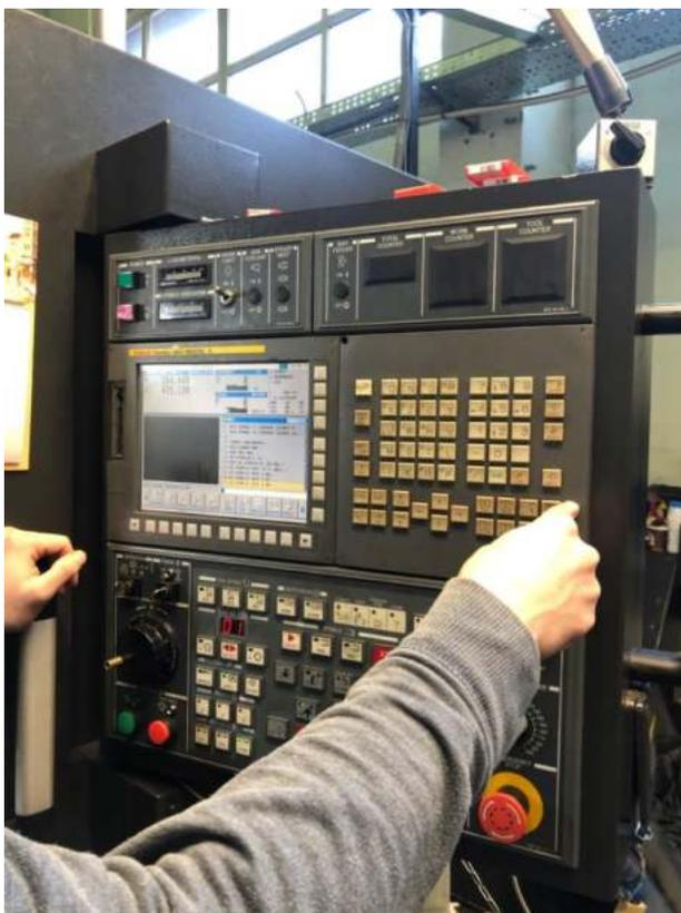
Рисунок 4.16 – Оператор вводит данные в алгоритм по выбору оптимального припуска с помощью стойки Fanuc токарного обрабатывающего центра Hyundai WIA L300C
