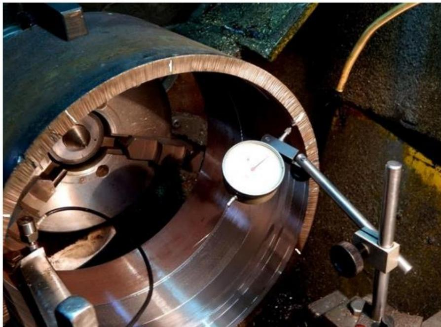
Рисунок 4.15 – Процесс измерения точности отверстия сварного образца
