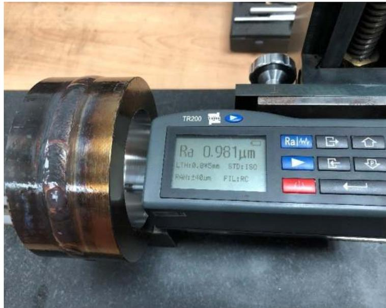
Рисунок 4.8 – Измерение шероховатости профилометром TR200
