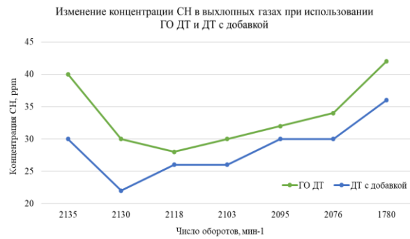
Рисунок 3 – Изменение количества вредных газов при использовании ДТ и ДТ с добавкой при максимальной нагрузке а) углеводороды; б) угарный газ
