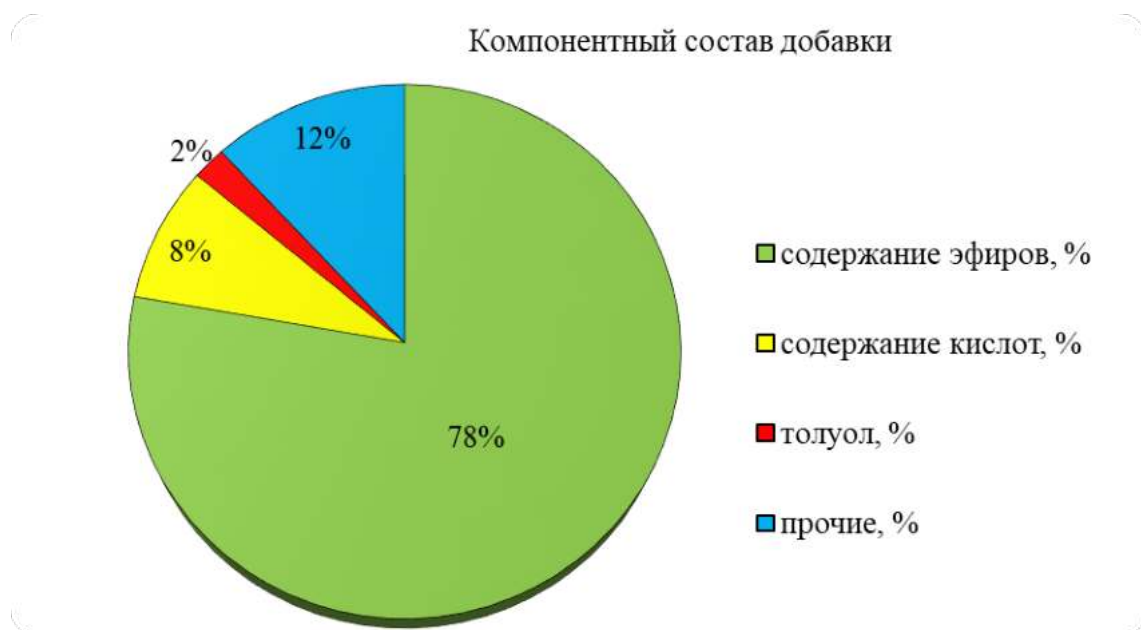
Рисунок 2.13 – Компонентный состав добавки, полученной по методу этерификации
