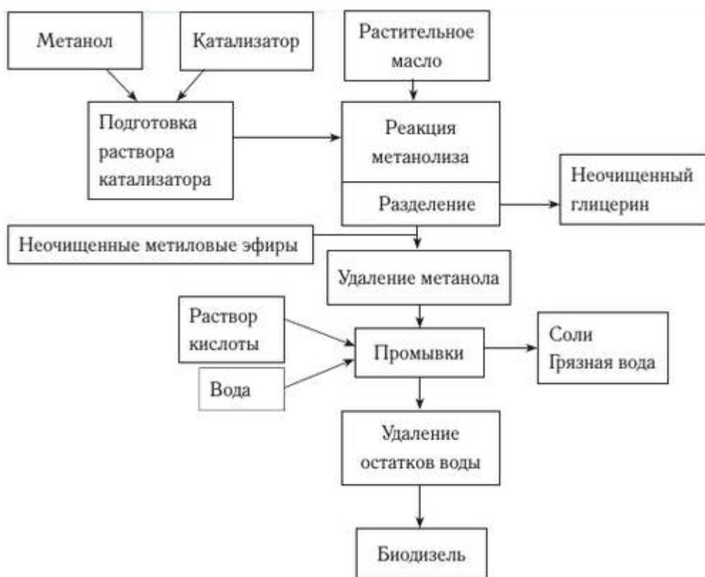
Рисунок 4.5 – Структурная схема технологического процесса производства добавок
