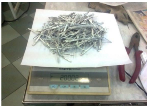
Рисунок 4.5 – Взвешивание дробленых вторичных металлизированных отходов
