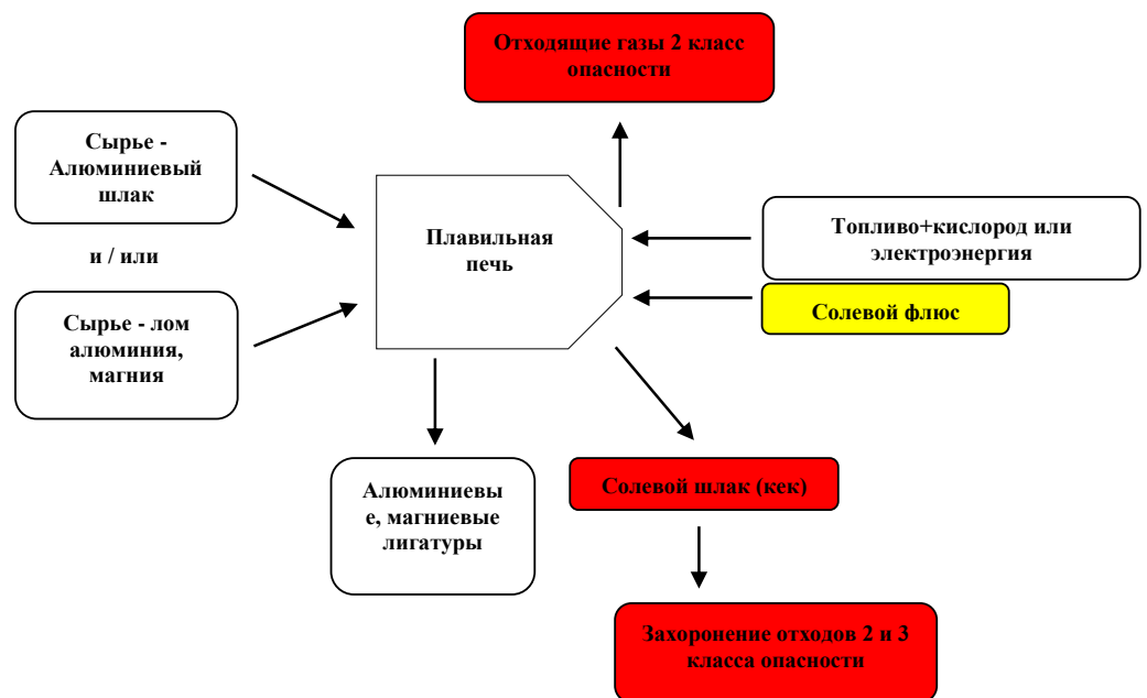
Рисунок 1.1 - Схема переработки металлизированных алюминиевых отходов в плавильном агрегате с применением солевых реагентов
