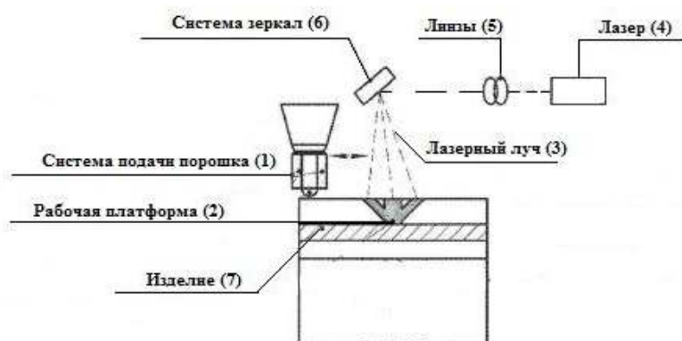
Рисунок 1.4 –Схема процесса селективного лазерного спекания [41]
