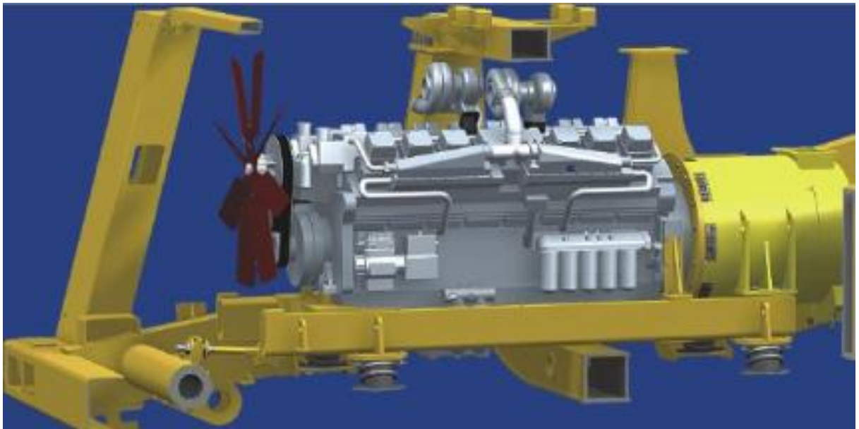
Рисунок 2.2 – Дизельный двигатель Cummins с синхронным тяговым генератором, устанавливаемый на автосамосвалы БелАЗ
