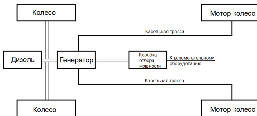
Рисунок 1.9 – Функциональная схема электромеханической трансмиссии с двумя ведущими мотор-колесами
