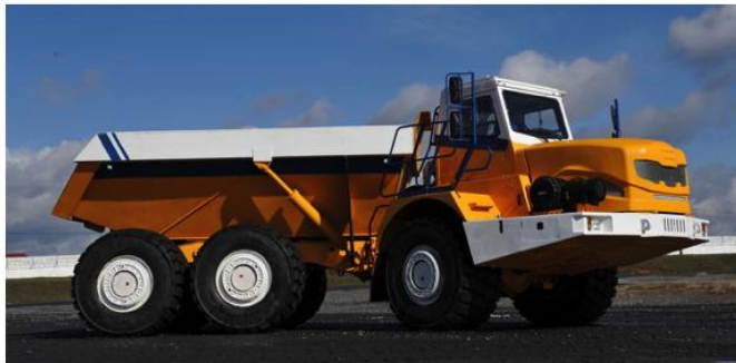
Рисунок 1.4 – Карьерный автосамосвал с шарнирно сочлененной рамой (а) и карьерный автосамосвал с жесткой рамой (б)
