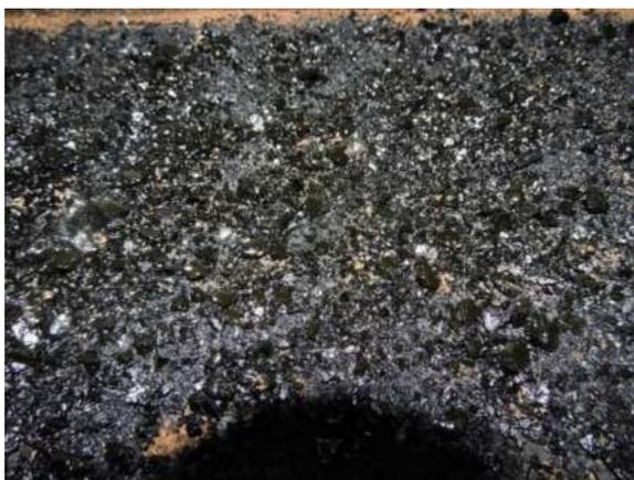
Рисунок 3.39 - Уголь, обработанный смесью газойлей с добавлением ТНО
