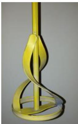
Рисунок 4.13 - Шнековая мешалка, используемая при эмульгировании ВАО
