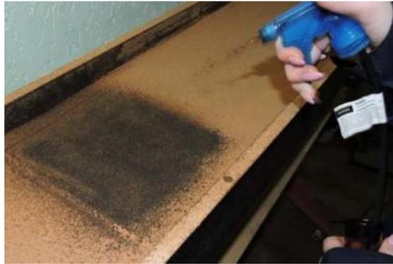
Рисунок 3.38 - Процесс нанесения, исследуемого ПС на пылящий материал
