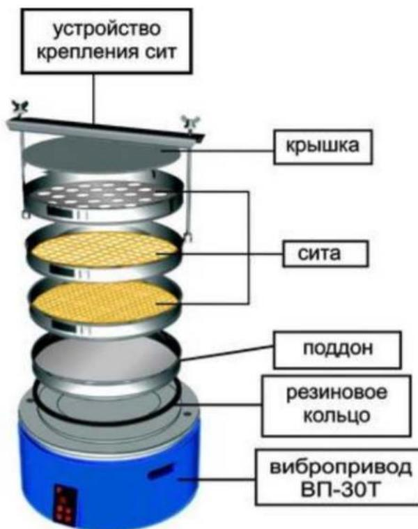
Рисунок 2.5 – Анализатор ситовой ВП-30Т
