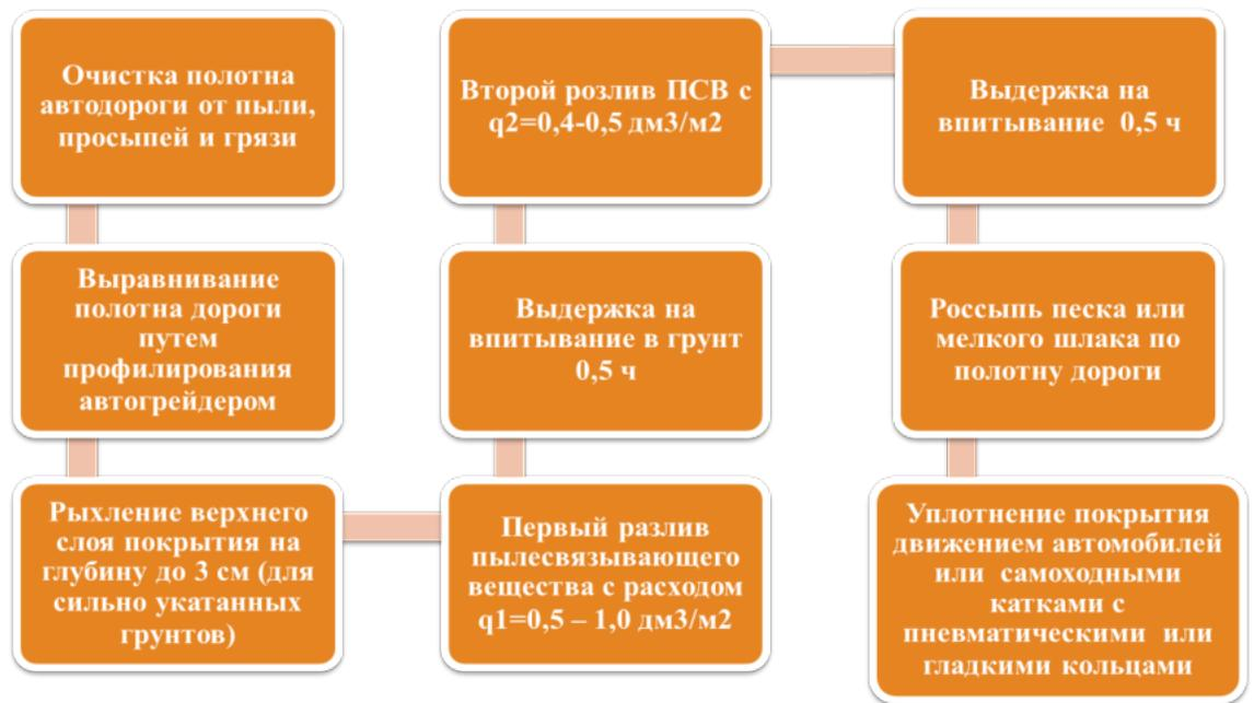
Рисунок 3.41 – Технологическая схема обработки автодорог ПС
