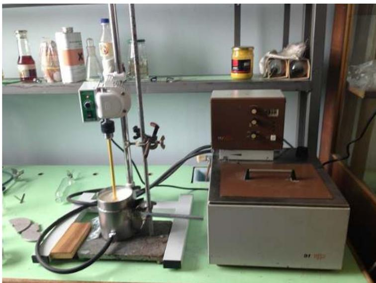
Рисунок 2.7 – Установка для эмульгирования
