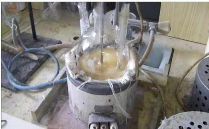
Рисунок 2.6 – Установка для синтеза алкидов
