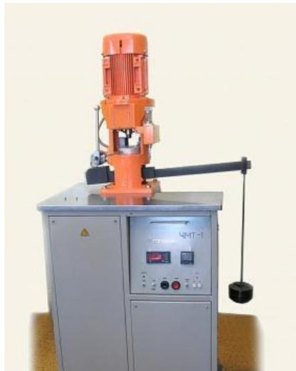
Рисунок 2.2 – Четырехшариковая машина трения (ЧШМ 3)
