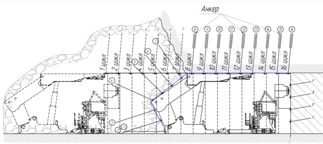
Рисунок 1 - Общий вид демонтажной камеры, сформированной механизированным комплексом
