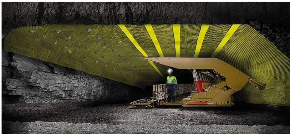
Рисунок 1.13 – Упрощенное изображение демонтажной камеры, сформированной согласно технологии 1-й группы с применением полимерной сетки
