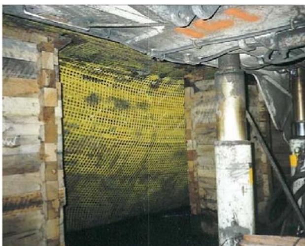
Рисунок 1.14 – Полимерная сетка сдерживает попадание пород из выработанного пространства в демонтажную камеру
