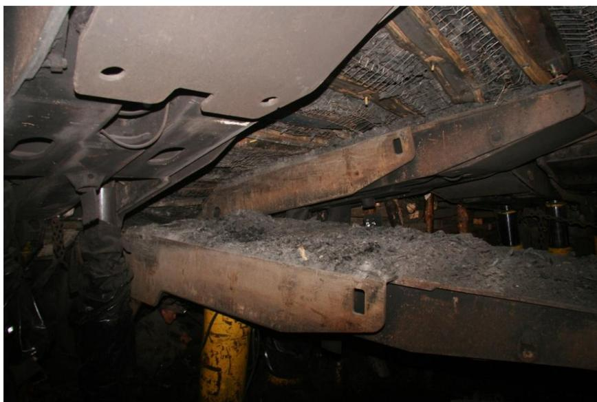
Рисунок 1.11 – Общий вид кровли демонтажной камеры, сформированной согласно технологии 1-й группы с применением решетчатой затяжки
