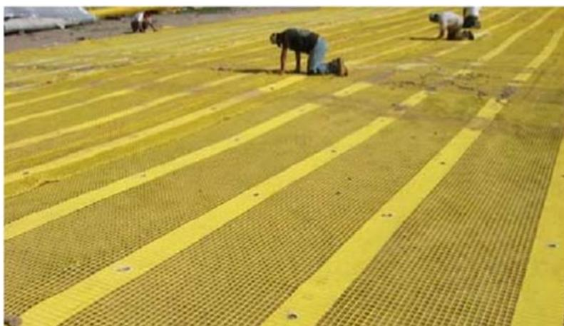
Рисунок 1.12 – Процесс сборки перекрытия на заводе-изготовителе перед отправкой потребителю
