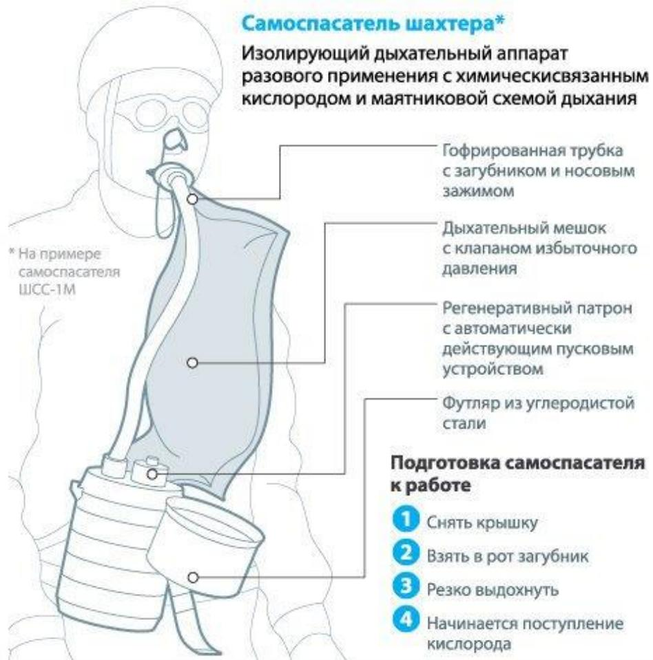
Рисунок 3.14 – Визуальное изображение устройства и принципа действия самоспасателей
