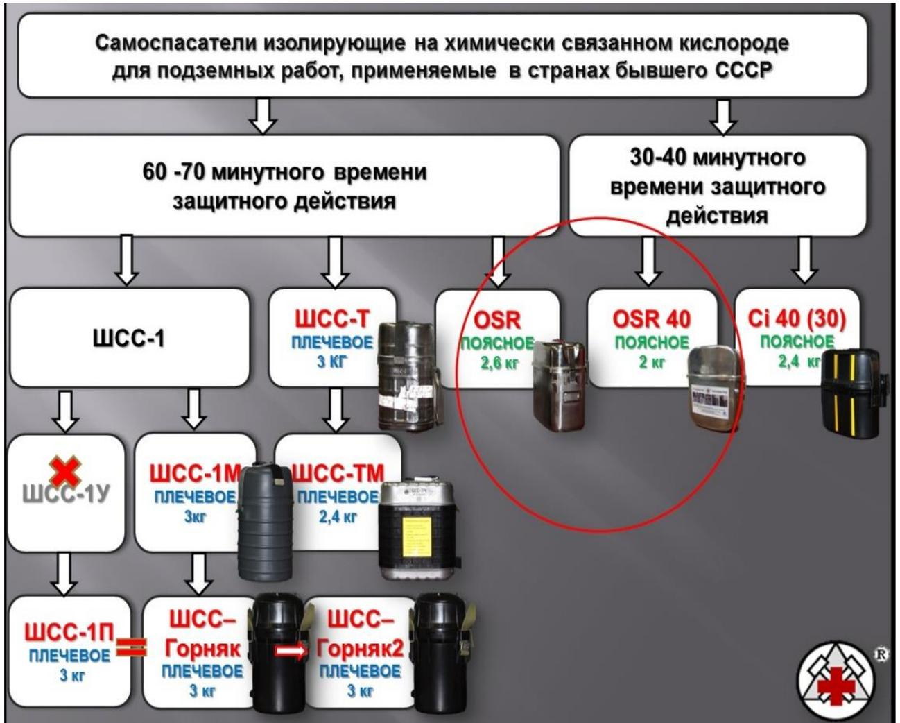
Рисунок 3.8 – Применяемые самоспасатели на шахтах АО «СУЭК-Кузбасс»
