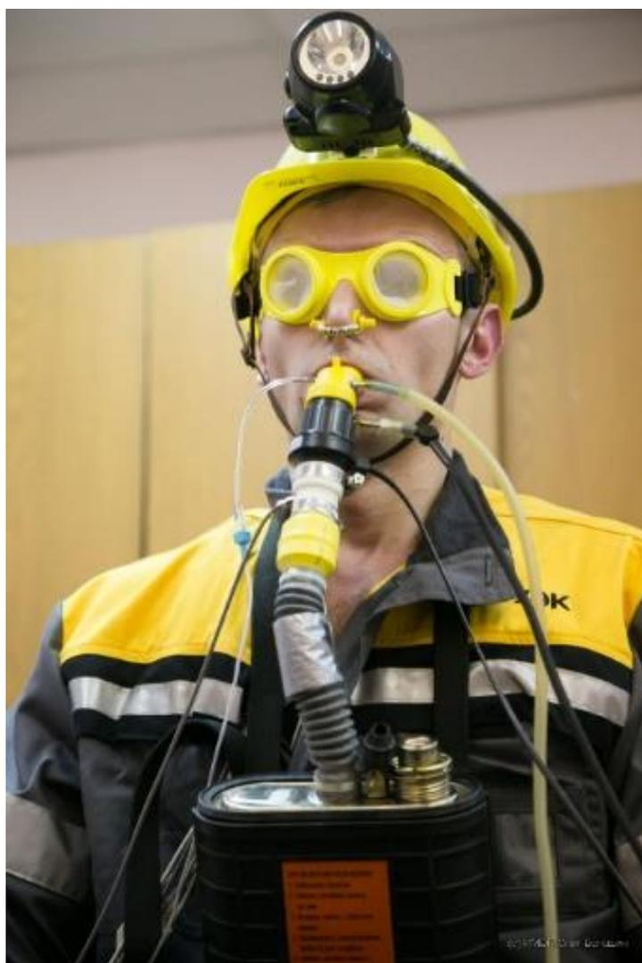
Рисунок 3.16 – Включенный самоспасатель ШСС-ТМ
