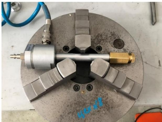
Рисунок 29 – Установка для проведения экспериментальных исследований опытного образца вихревой трубки
