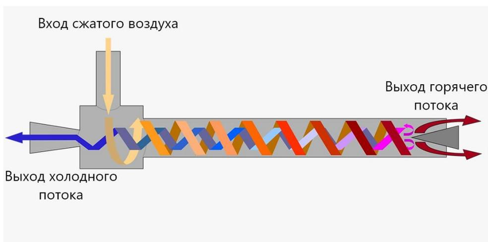
Рисунок 26 – Схема температурного разделения потока воздуха в вихревой трубке
