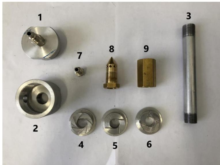
Рисунок 31 – Опытный образец вихревой трубки в разобранном виде:
