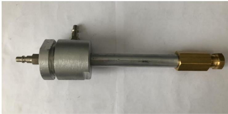
Рисунок 30 – Опытный образец вихревой трубки в собранном виде
