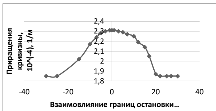
Рисунок 5- Зависимость приращения суммарной кривизны от взаимного положения границ остановки очистных работ.
