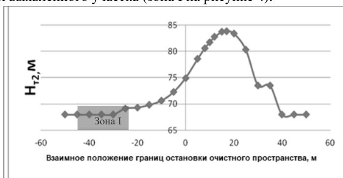
Рисунок 4 – Высота зоны водопродящих трещин в зависимости от взаимного положения границ остановки очистных работ: Зона I - участок, где высота зоны водопродящих трещин практически не изменяется.
