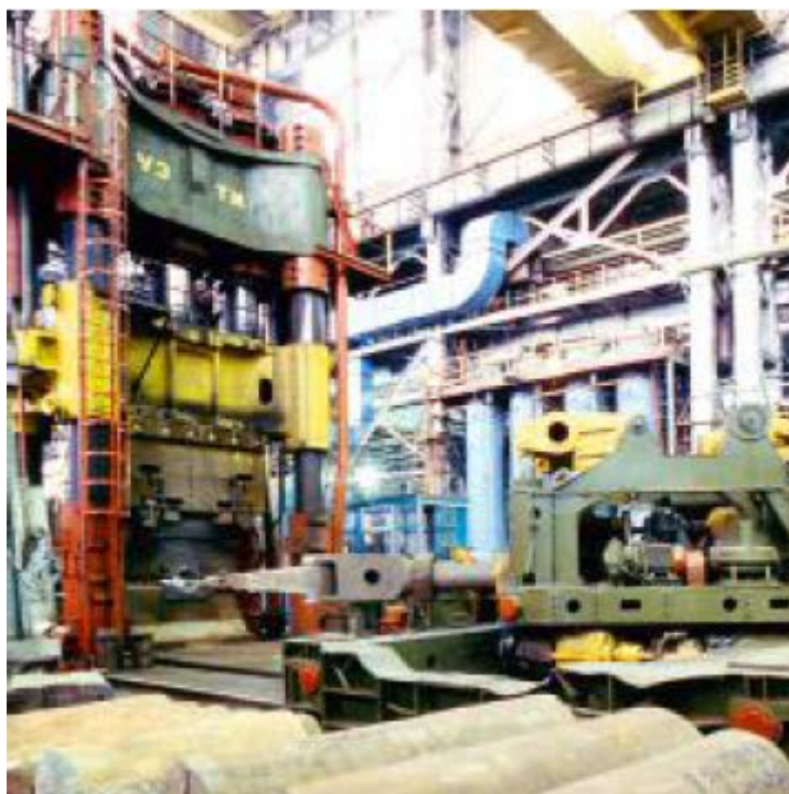
Рисунок 4.9 – Штамповочный пресс УЗТМ, развивающий усилие 200 МН
