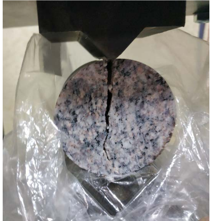
Рисунок 2.13 – Оснастка экспериментального стенда по изучению влияния радиуса притупления индентора на усилие и энергоёмкость процесса разрушения гранита: 1 – индентор, 2 – фрагмент породы, 3 – вставка
