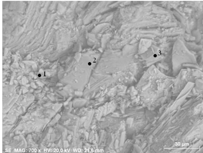
Рисунок 2.6 – Сильносерпентинизированный дунит (степень серпентинизации 80%) рудопроявления Высоцкого. Микрофотографии в обратно-рассеянных электронах (BSE)
