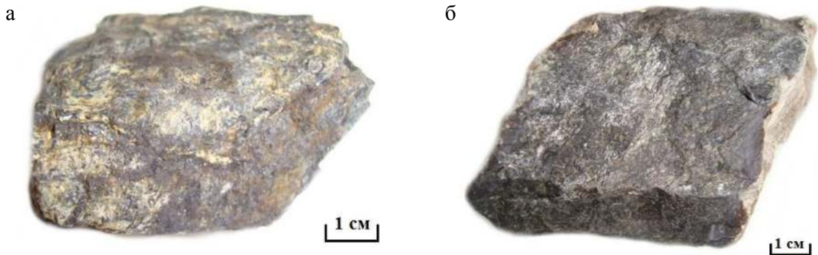
Рисунок 1.16 – а, б) Антигоритизированные дуниты, рудопроявление Высоцкого Хлоритовые породы. Хлоритовые жилы мощностью до 2-3 см рассредоточены в пределах массива и, кроме того, образуют штокверки в катаклазированных серпентинизированных дунитах. Они наиболее развиты в периферической и средней частях массива и обычно приурочены к дайкам и жилам горнблендитов (рисунки 1.17).
