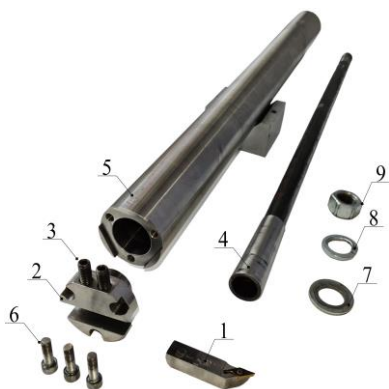
Рисунок 2 – Конструкция antivибрационной расточной оправки, где: 1 – державка; 2 – резцовая головка; 3 и 6 – винты; 4 – разжимной стержень; 5 – корпус оправки; 7 – шайба; 8 – контргайка; 9 – гайка
