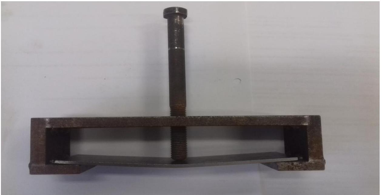
Рисунок 4.5 – Изгиб пластины в струбцине
