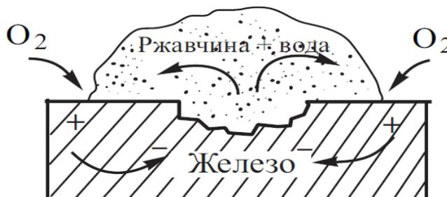
Рисунок 2.11 – Элемент дифференциальной аэрации на корродированной поверхности железа [28]
