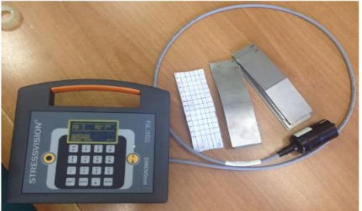
Рисунок 4.10 – Сканер механических напряжений Stress Vision
