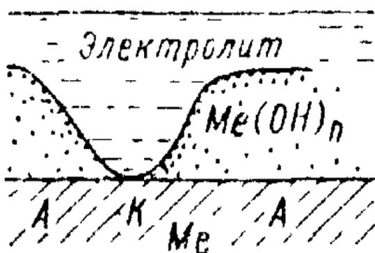
Рисунок 2.10 – Образование коррозионного гальванического элемента вследствие неоднородности вторичных продуктов коррозии и осадка на поверхности металла [28]
