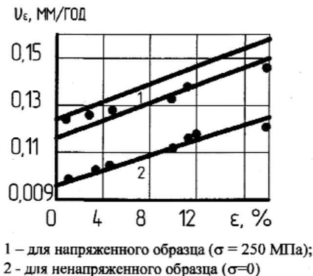
Рисунок 2.27 – График зависимости скорости коррозии трубной стали 10 от степени деформации [48]
