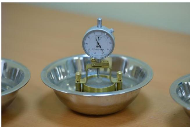
Рисунок 2.4 – Прибор для определения свободного набухания грунтов –ПНГ-1
