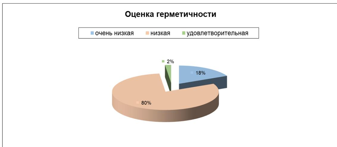
Рисунок 1.6 – Оценка герметичности цементного кольца на примере обсадной колонны – кондуктора Бованенковского месторождения
