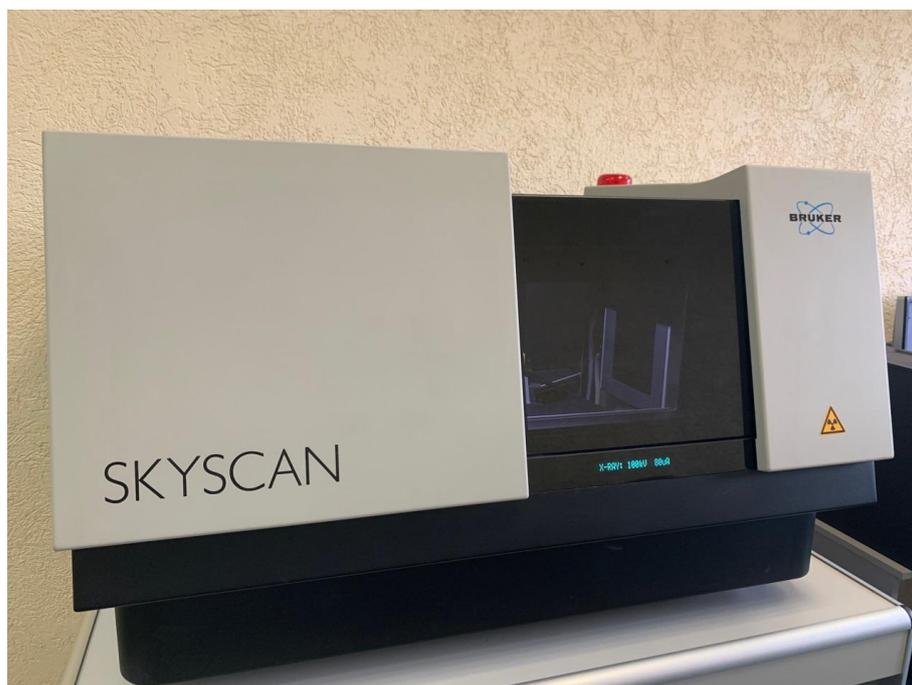
Рисунок 2.9 – Микротомограф SkyScan 1173
