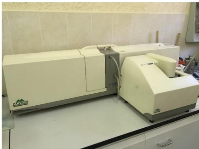
Рисунок 2.1 – Лазерный микроанализатор «MASTERSIZER»
