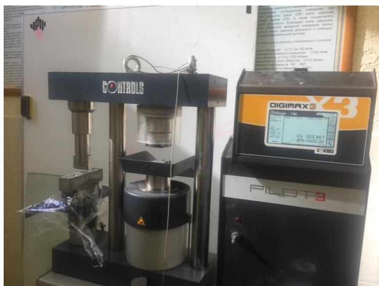
Рисунок 2.6 – Полуавтоматическая машина для испытания на сжатие и на изгиб Controls – Pilot3.
