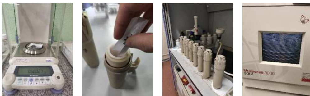
Рисунок 2.6 – Процесс пробоподготовки для определения подвижных форм элементов
