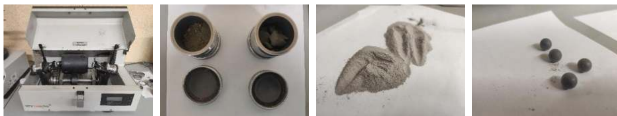
Рисунок 2.4 – Процесс подготовки проб отходов на шаровой мельнице
