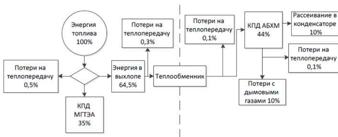
Рисунок 2.7 – Схема энергетического баланса тригенерационного энергетического комплекса
