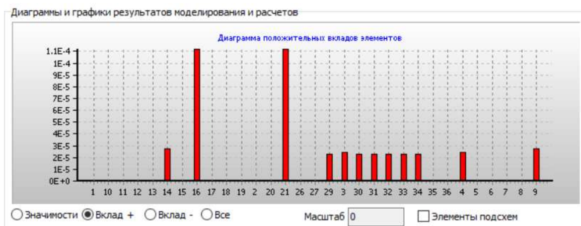
Рисунок 4.12 – расчетные показатели положительных вкладов элементов итоговой системы электроснабжения с внедрением АФ и ТАВР
