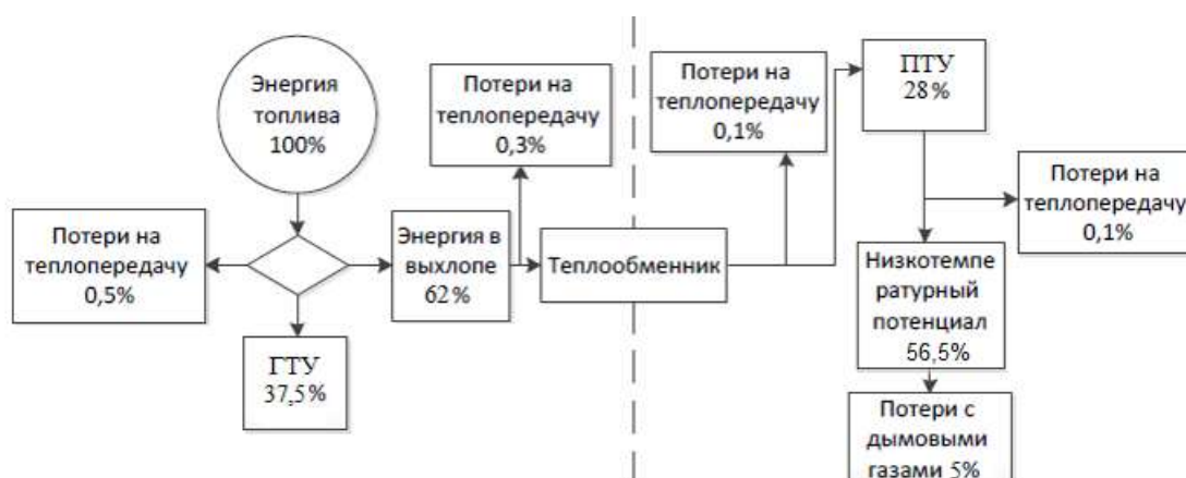
Рисунок 1.2 – Структура баланса энергии первичного энергоносителя электротехнического комплекса с режимом когенерации и бинарным циклом
