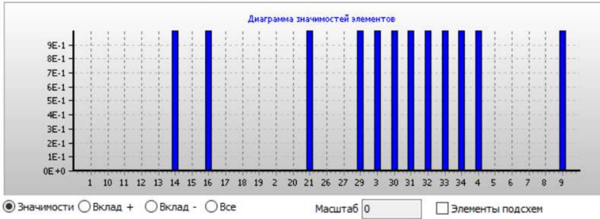
Рисунок 3.13 – Значимость элементов системы электроснабжения
