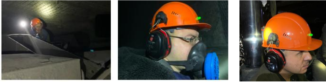
Рисунок 4.10 – Апробация прототипа СИЗОС с функциями мониторинга и сигнализации проходчиком и МГВМ
