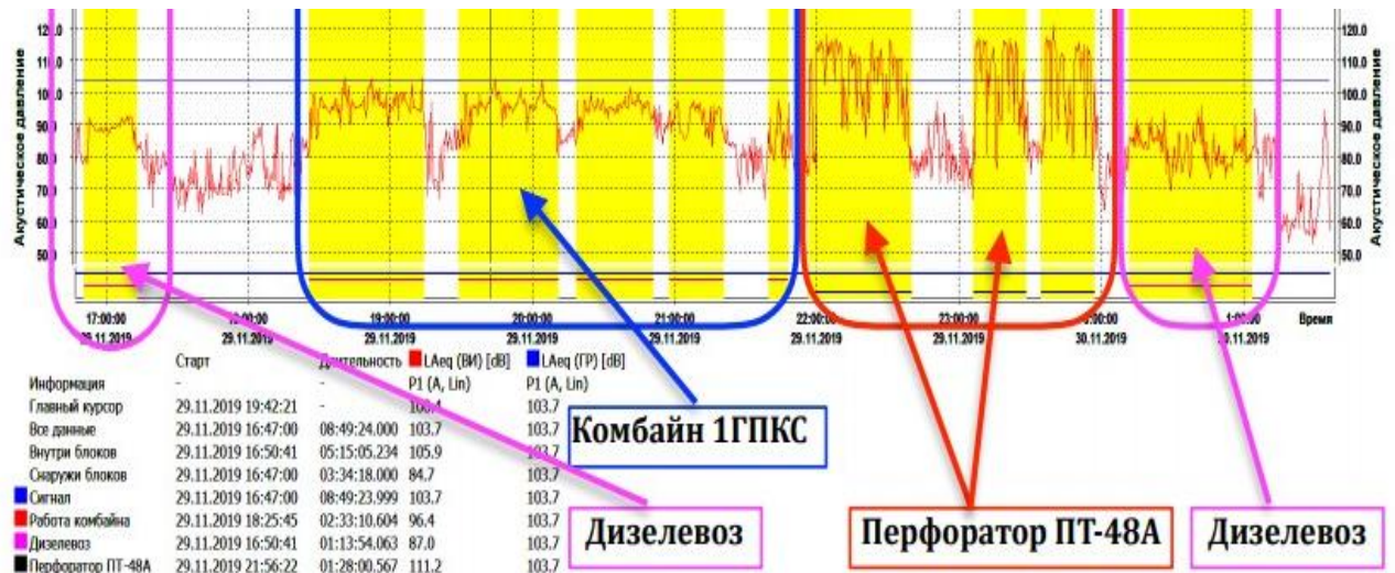
Рисунок 3.2 – Определение основных источников шума в течение рабочей смены (проходчик)
