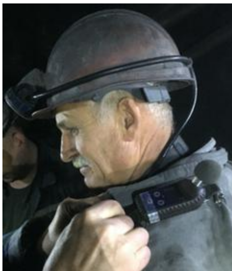
Рисунок 2.3 – Крепление индивидуального шумомера типа SV 104 на плече у работника
