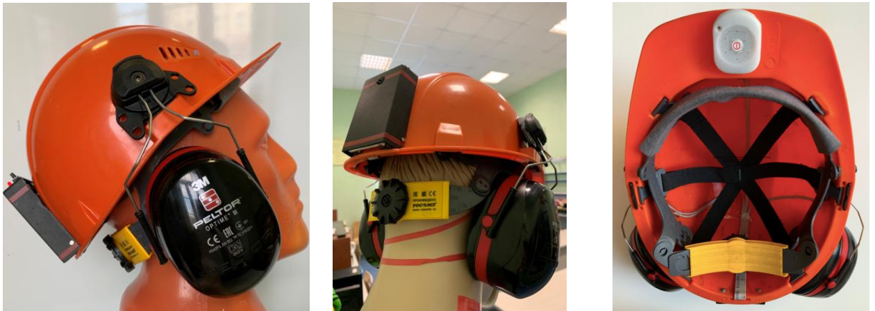
Рисунок 4.8 – Изготовленный прототип СИЗОС с функциями мониторинга и сигнализации
