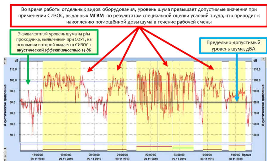
Рисунок 3.6 – Графическое отображение превышения уровня шумового воздействия защитных свойств (акустической эффективности) СИЗОС, выданных проходчику на основе результатов СОУТ
