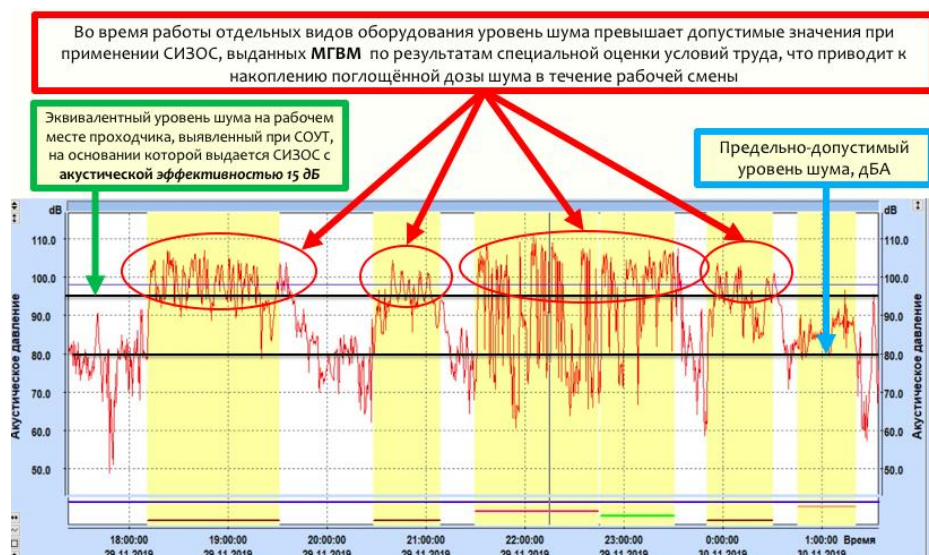
Рисунок 3.7 – Графическое отображение превышения уровня шумового воздействия защитных свойств (акустической эффективности) СИЗОС, выданных МГВМ на основе результатов СОУТ
