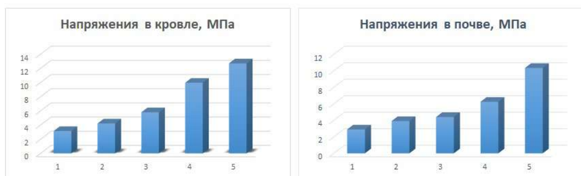
Рисунок 3.3 – Напряжения в кровле и почве дополнительной выработки 1 - до начала влияния опорного давления лавы; 2 - в зоне влияния опорного давления первой лавы; 3 - в зоне остаточного опорного давления первой лавы; 4 - в зоне опорного давления второй лавы; 5 - в зоне остаточного опорного давления второй лавы
