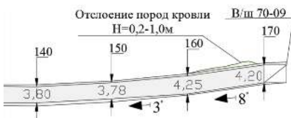
Рисунок 2.15 – Результаты наблюдений за состоянием кровли на участке лавы у вентиляционного штрека 70-09
