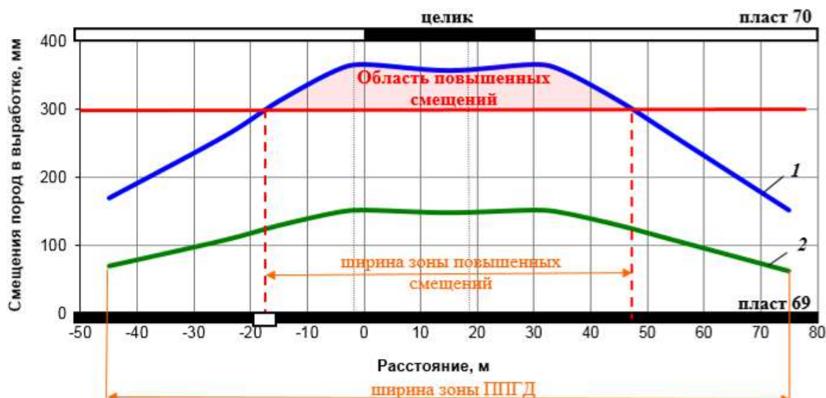
Рисунок 4.5 – Смещения кровли конвейерного штрека 69-07, закрепленного анкерной крепью и расположенного по пласту 69 в зоне ПГД от целика по пласту «70»: 1 – в зоне влияния лавы 69-07; 2 – до начала отработки запасов выемочного столба 69-08
