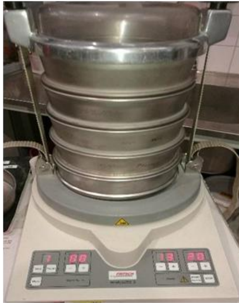
Рисунок 2.6 – Устройство для разделения сыпучих веществ по гранулометрическому составу
