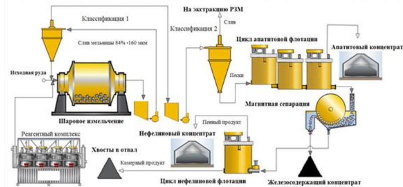
Рисунок 13 – Разработанная технологическая схема для комплексной переработки апатит-нефелиновых Хибинских руд
