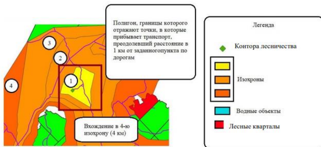
Рисунок 10 – Оценка доступности лесного квартала методом построения изохрон и графов
