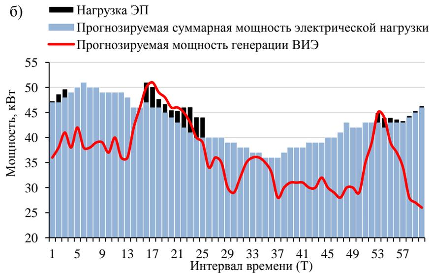
Рисунок 6 – а: индивидуальный график нагрузки ЭП с прерываемым циклом работы, б – оптимальное распределение интервалов работы ЭП генетическим алгоритмом в условном рассмотренном примере
