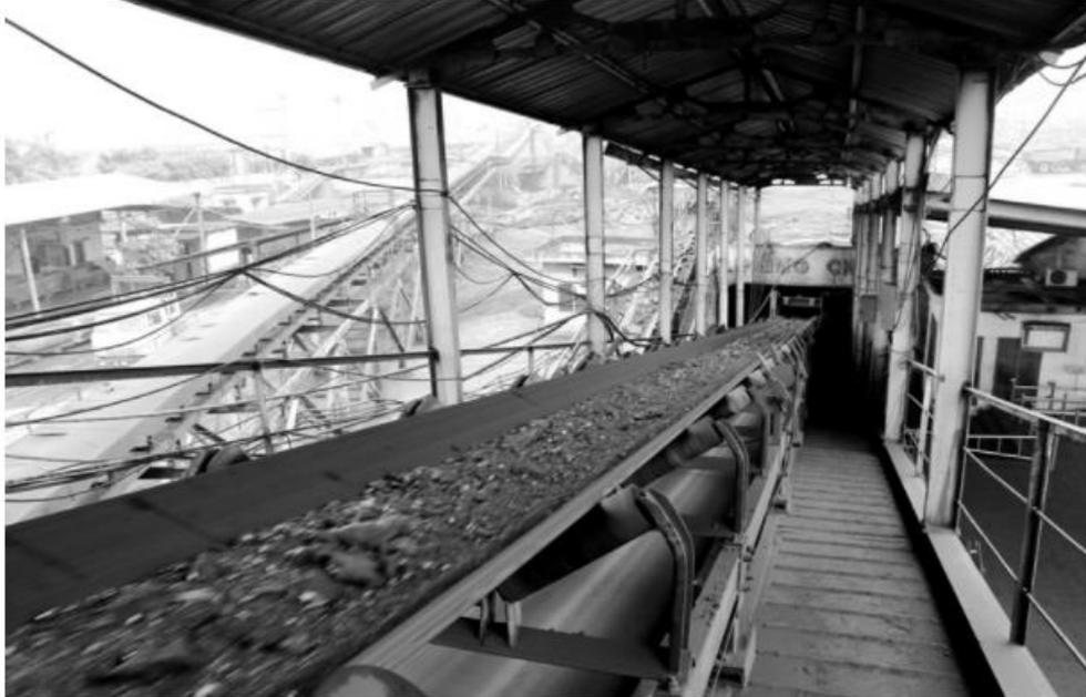
Рисунок 1.3 – Конвейерная линия от -230 м до +30 м (на земле) шахты Маохе в угольном бассейне Куангнинь
