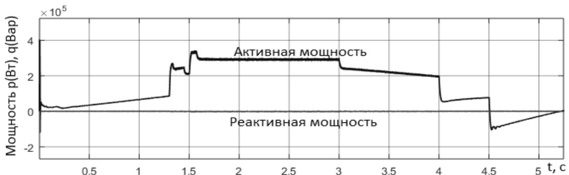
Рисунок 4.20 – Характеристики мгновенной активной и реактивной мощности, когда АВН работает в режиме выпрямителя и в режиме инвертора
