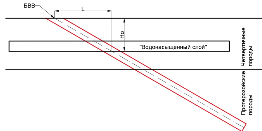
Рисунок 12 – Схема к определению положения точки максимального оседания
