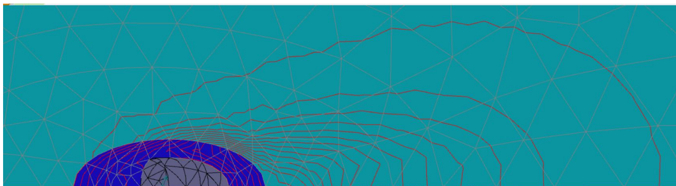
Рисунок 3.27 – Распределение вертикальных сдвижений в период пассивной стадии замораживания станции метро «Проспект Славы II» (вид в плане)
