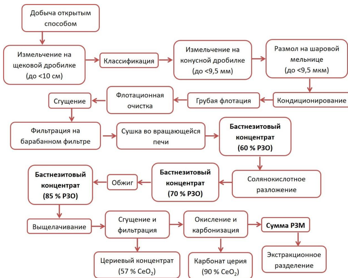
Рисунок 1.5 – Схема переработки бастнезитового (карбонатного) сырья [27]
