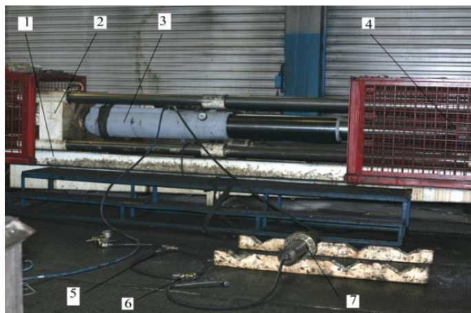
Рисунок 4 – Экспериментальные исследования блока БРС. Нагрузочный стенд ООО «Завод Красный Октябрь»: 1 – направляющие; 2, 4 – нажимные каретки; 3 – гидростойка; 5 – дроссель и обратный клапан; 6 – вентиль; 7 – мультипликатор давления
