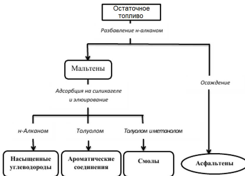
Рисунок 2.8 – Схема разбавление остаточных топлив для определения группового состава топлив
