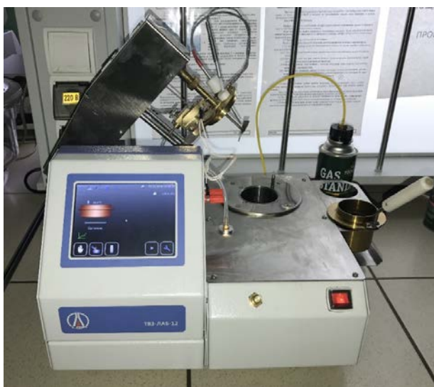
Рисунок 2.4 – Аппарат для определения температуры вспышки в закрытом тигле ТВЗ-ЛАБ-12
