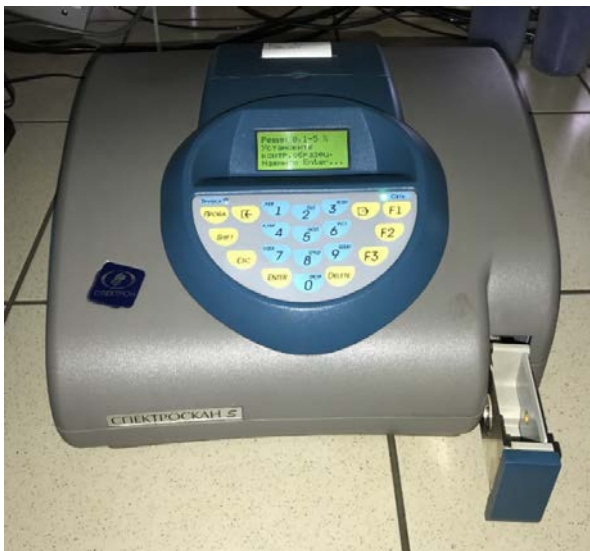
Рисунок 2.3 - Рентгеновский энергодисперсионный анализатор серы Спектроскан S
