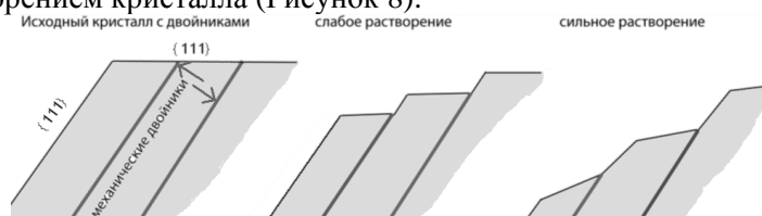
Рисунок 8 – Схема образования деформационной штриховки при растворении алмаза со слоями механического двойничания (показаны стрелками)
