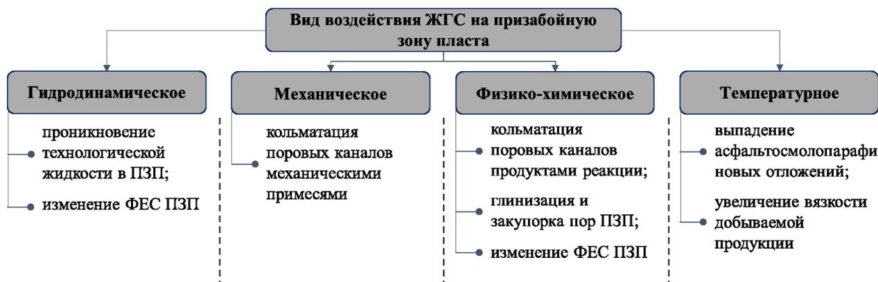
Рисунок 1.3 – Виды воздействия технологических жидкостей на призабойную зону пласта
