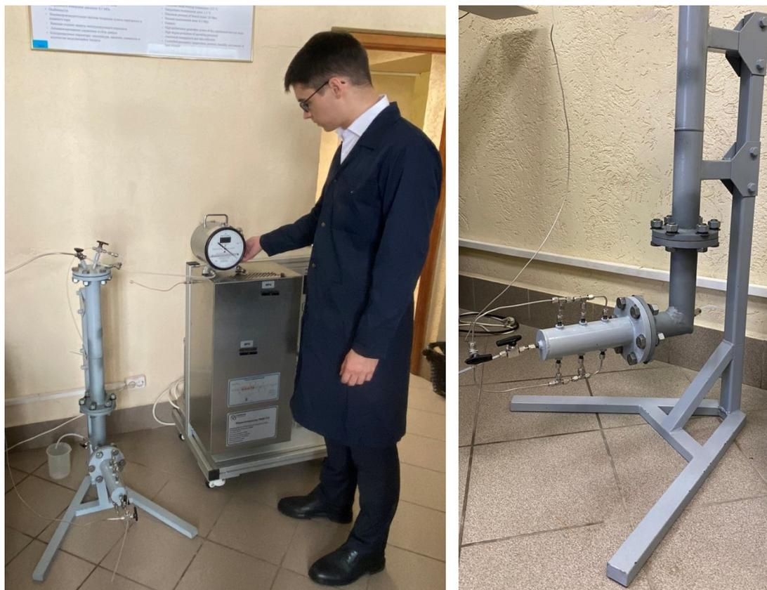
Рисунок 2.4 – Стенд для оценки газоблокирующих свойств жидкостей глушения скважин
