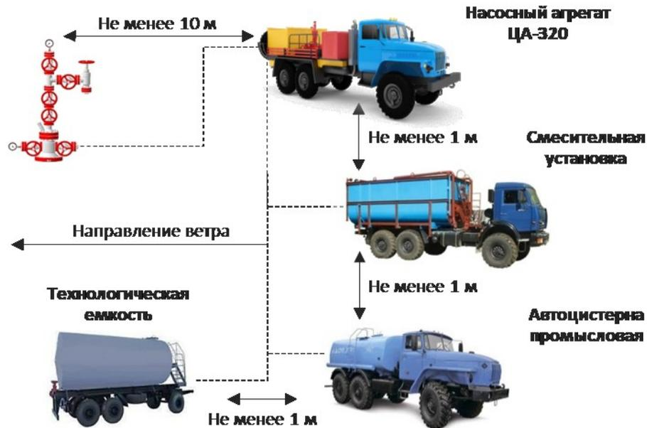
Рисунок 4.1 – Схема расстановки техники при глушении скважины
