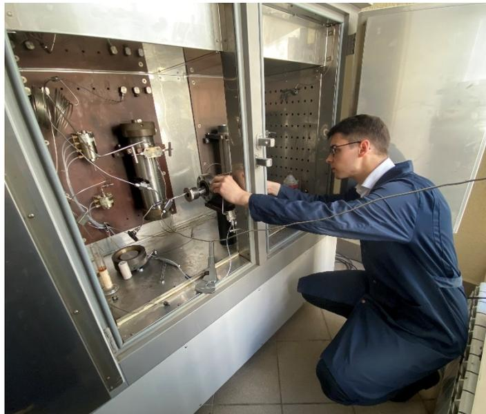
Рисунок 2.6 – Кернадержатель и термощкаф фильтрационной установки RPS-812 (Coretest Systems Corporation)
