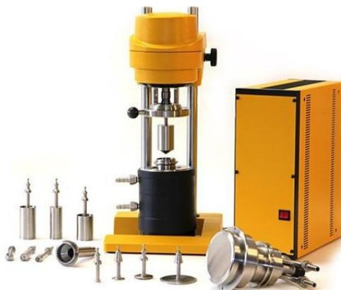
Рисунок 2.2 – Ротационный автоматизированный вискозиметр Rheotest RN 4.1
