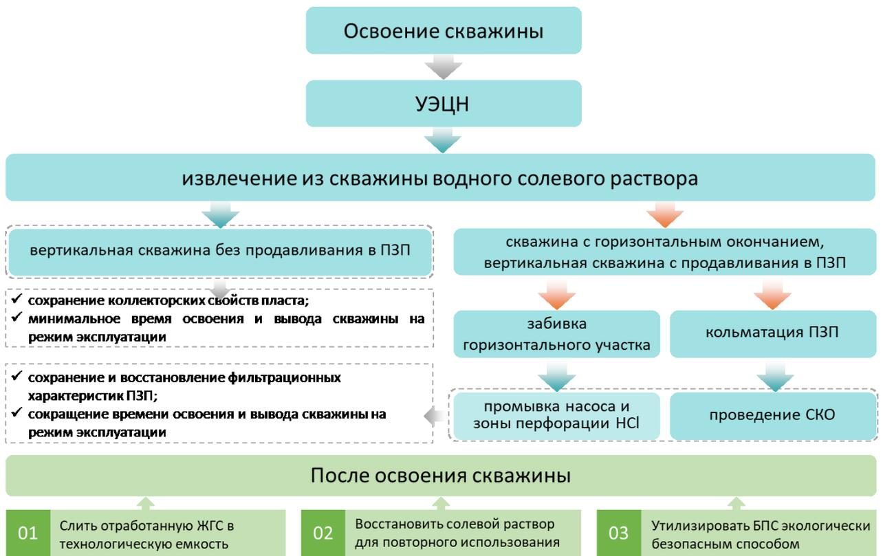
Рисунок 4.6 – Схема освоения вертикальных и горизонтальных скважин после проведения подземного ремонта с (и без) продавливания блокирующего состава в ПЗП
